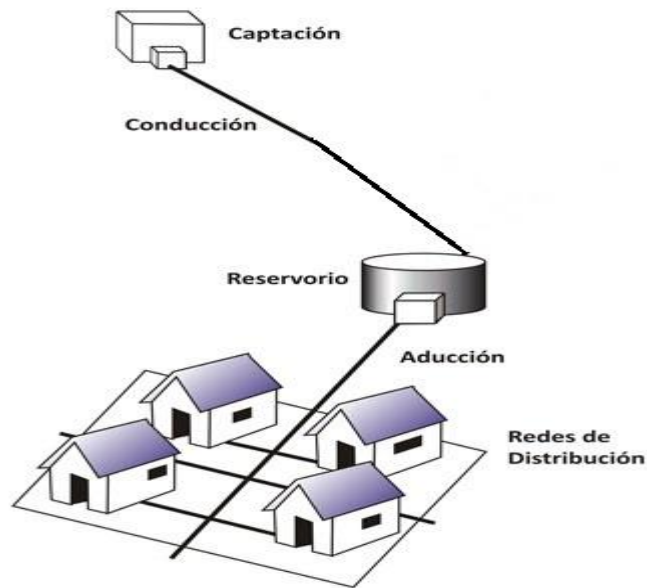
Figura 01: Sistema de agua potable rural
