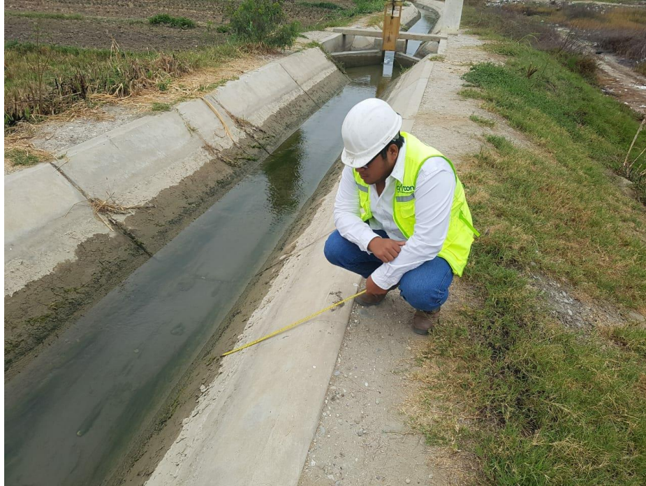
Gráfico 93: Obteniendo las dimensiones del canal
