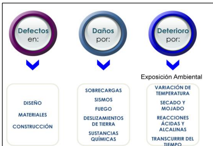
Cuadro 1: Causas de Patología.
