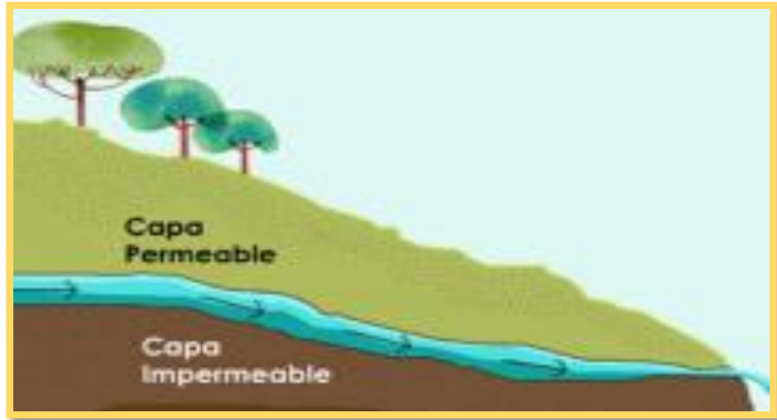
Figura 03: Manantial de ladera.
