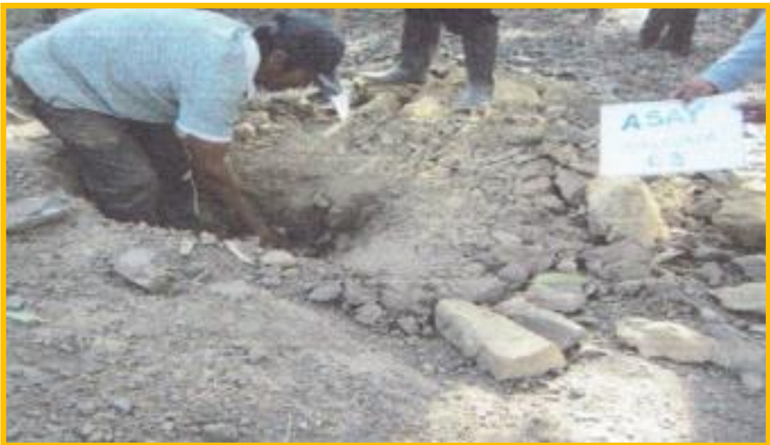
Imagen N° 17: Se observa realizando la calicata 3 de exploración subterránea en la localidad de Asay.
