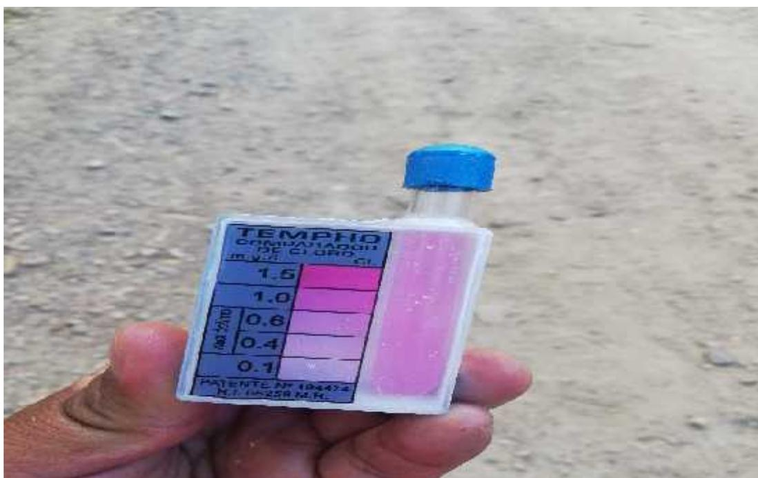
Imagen N° 20: Vista de nivel de clorador de agua potable en la comunidad de Lllullucha Ccata.
