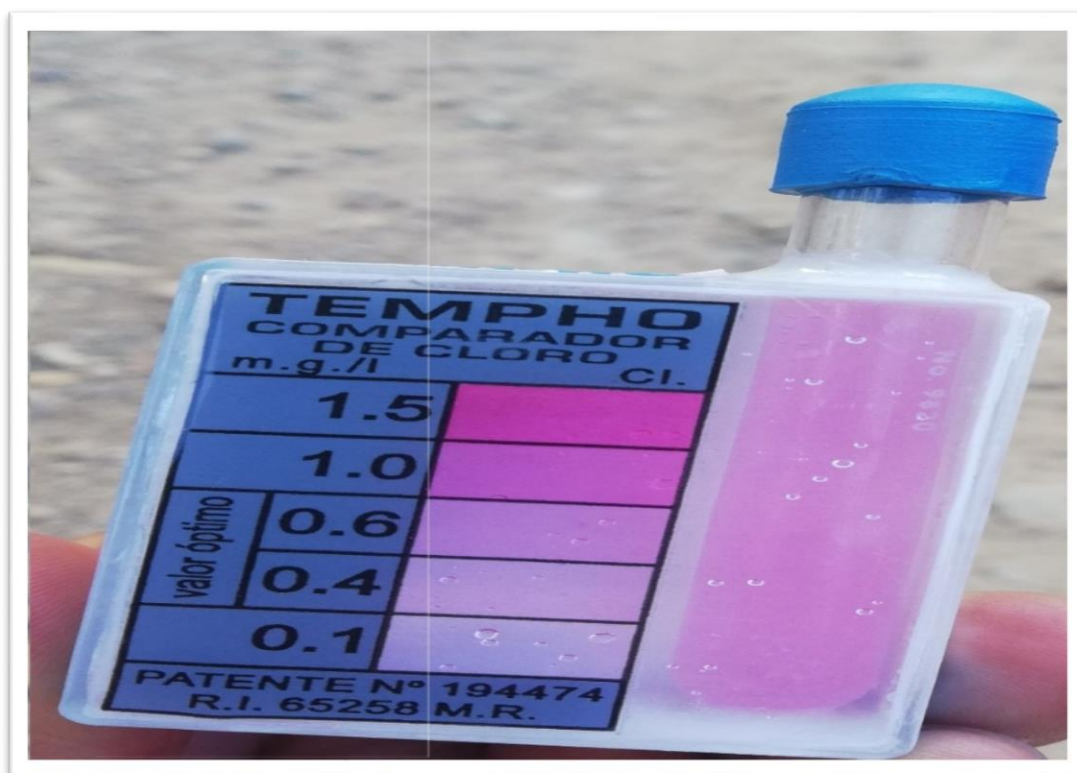
Imagen 12: Vista de nivel de cloración de agua potable, en la comunidad de Unya.
