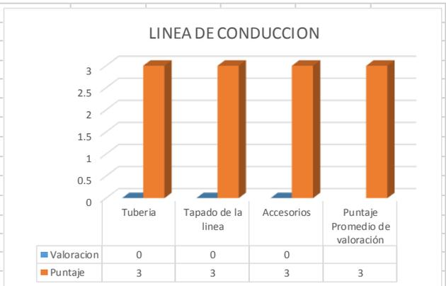
Se puede concluir que la línea de conducción de nuestro sistema de agua potable se encuentra en buenas condiciones, porque en toda su longitud está bien enterrada no se encuentra tramos al aire y tampoco filtraciones superficiales en ella que pueda ocasionar pérdida de caudal en la conducción.
