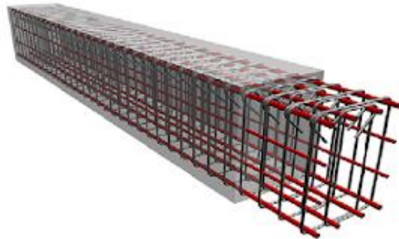
Figura 08. Armadura de viga de concreto armado.
