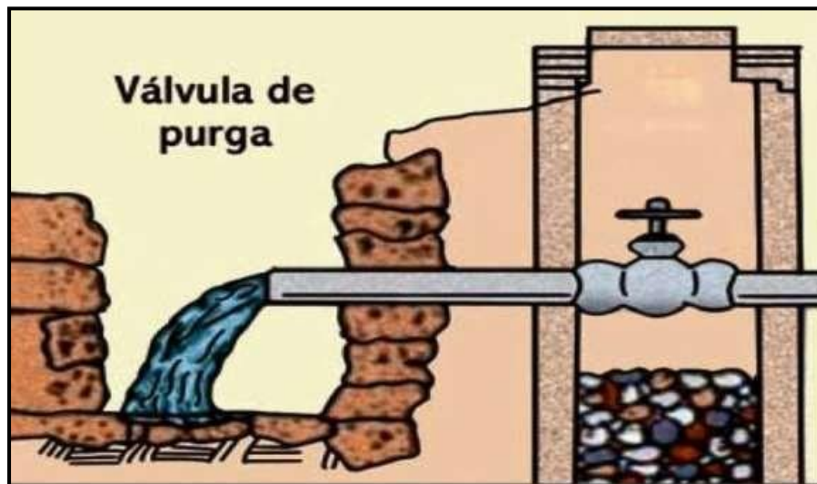
Gráfico 12 Vista de perfil de válvula de purga.
