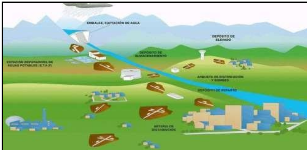
Gráfico 2 Sistema de abastecimiento de agua potable.
