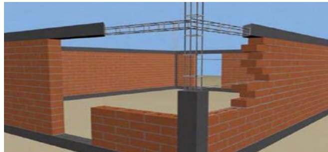
Gráfico 5: Figura de albañilería confinada Fuente: Ejemplo de aplicación de la albañilería confinada (2016)
