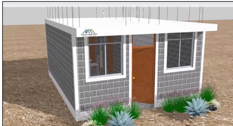
Gráfico 04: Construcción de vivienda tipo albañilería armada.
