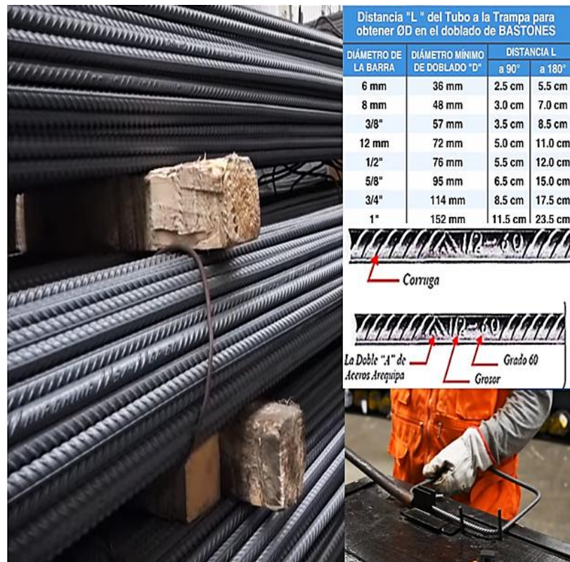
Figura 15: Detalle de las características del acero de refuerzo y sus diferentes diámetros para doblado de bastones para estribos.
