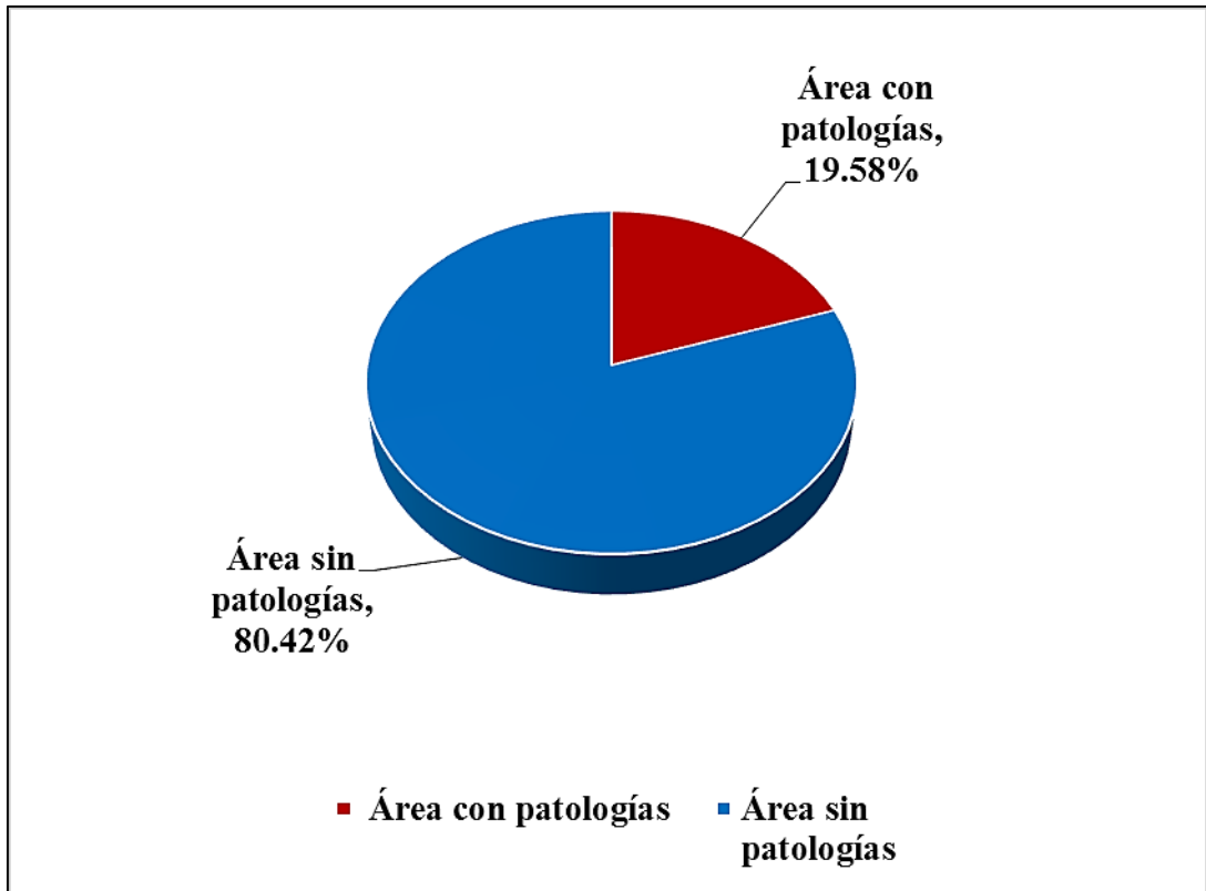
Figura 50: Porcentaje del área con y sin patologías en la unidad muestral 02. Nota. Fuente: Elaboración propia. (2019).
