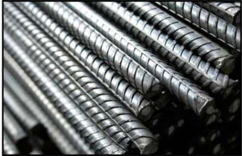
Gráfico 12: barras de acero de refuerzo corrugado
