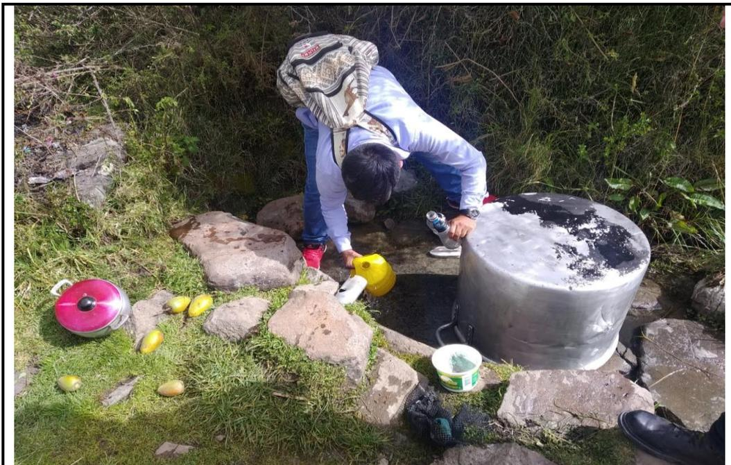
IMAGEN N° 5: TOMA DE MUESTRA PARA CALCULAR EL CAUDAL DEL MANANTIAL
