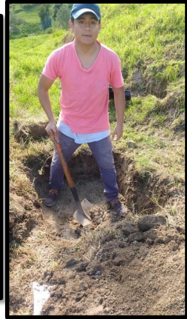
d) Fotografía 4: Realización de calicatas y toma de muestras para estudio de suelo.
