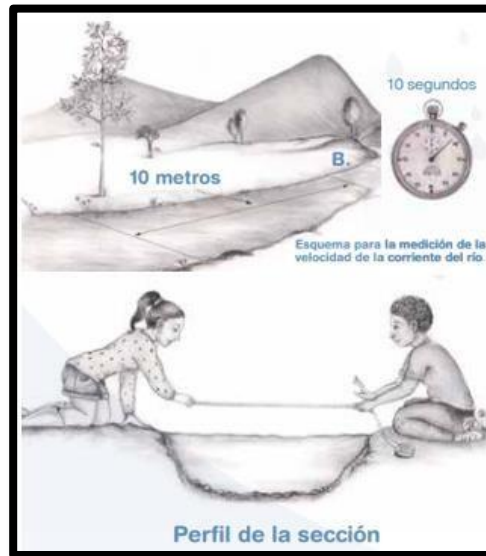
Figura3: Medición de caudal, método velocidad – área. Fuente: Evaluación de recursos hidroeléctricos, programas de energía, infraestructura y servicios básicos. (2014)
