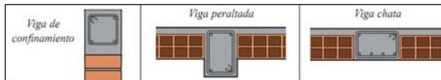
*Figura 5.* Detalle de los tipos de viga de concreto armado.
