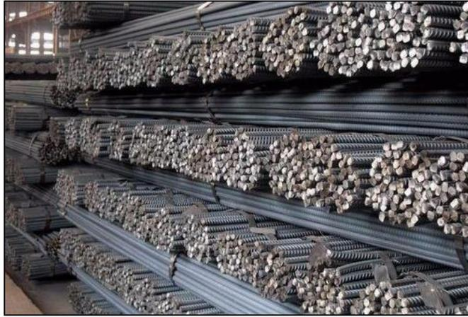
*Figura 9. Varillas de acero corrugado.*
