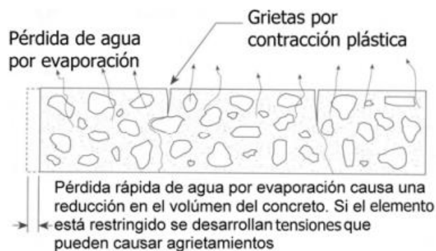
Gráfico N° 11: Esquema de contracción por secado en el concreto
