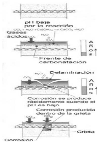
Gráfico N° 7: Esquema de deterioro causado por la carbonatación
