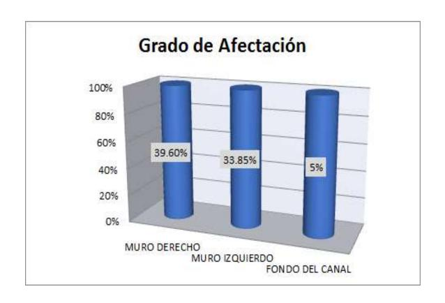
UNIDAD MUESTRAL 06: Las patologías con mayor presencia en los muros laterales fueron la GRIETA y FISURA aunque solo tengan un nivel de Leve podrían aumentar su grado de afectación. Además la patología con mayor nivel de severidad es la EROSIÓN con un porcentaje de 22.2%, tanto en el margen derecho e izquierdo en un área evaluada de 8 m² cada uno.
