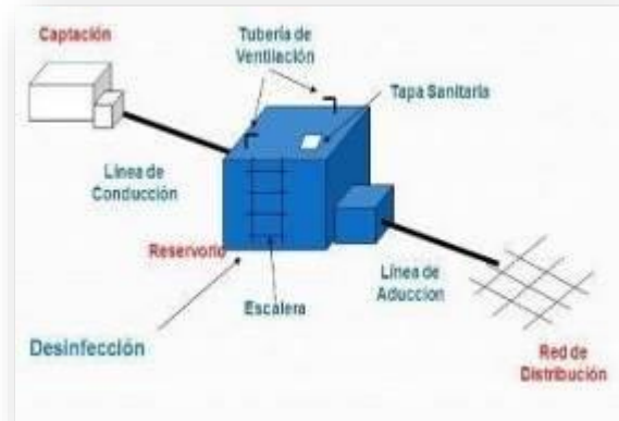
Figura 7. Sistema de Abastecimiento de agua por gravedad
