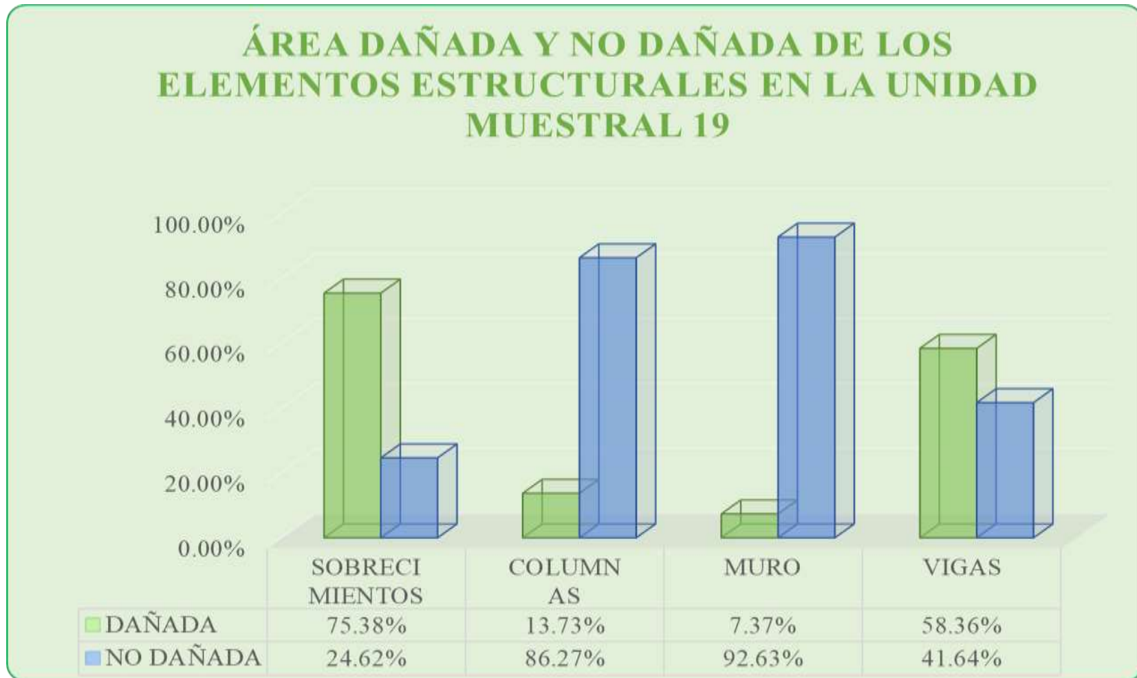
Gráfico 76: Porcentaje de Área dañada y no dañada de los Elementos Estructurales en la Unidad Muestral 19.
