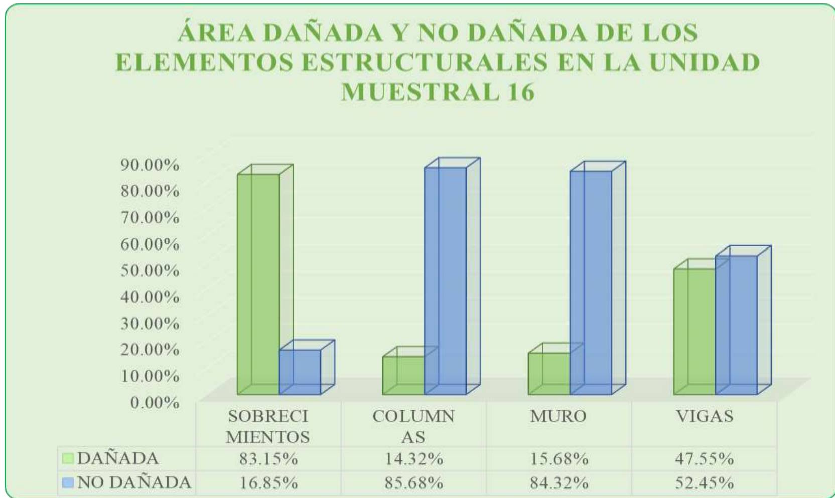
Gráfico 64: Porcentaje de Área dañada y no dañada de los Elementos Estructurales en la Unidad Muestral 16.
