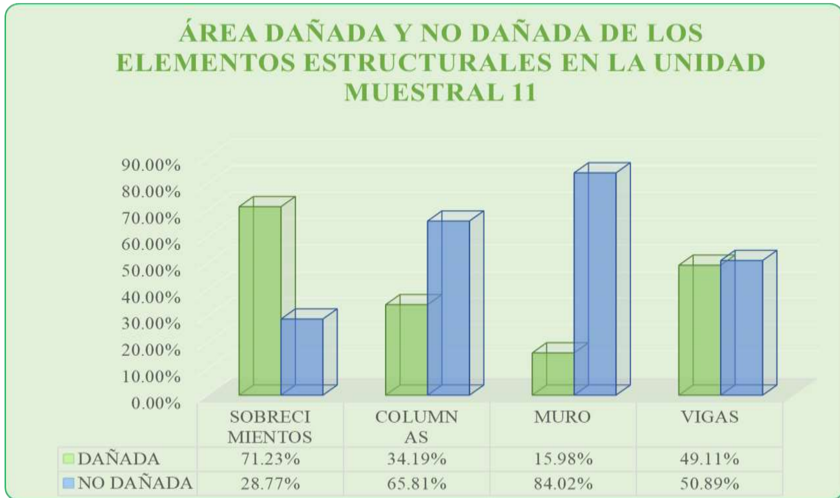
Gráfico 44: Porcentaje de Área dañada y no dañada de los Elementos Estructurales en la Unidad Muestral 11.
