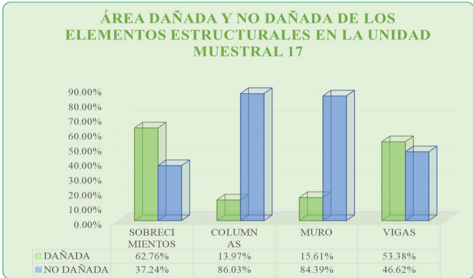
Gráfico 68: Porcentaje de Área dañada y no dañada de los Elementos Estructurales en la Unidad Muestral 17.
