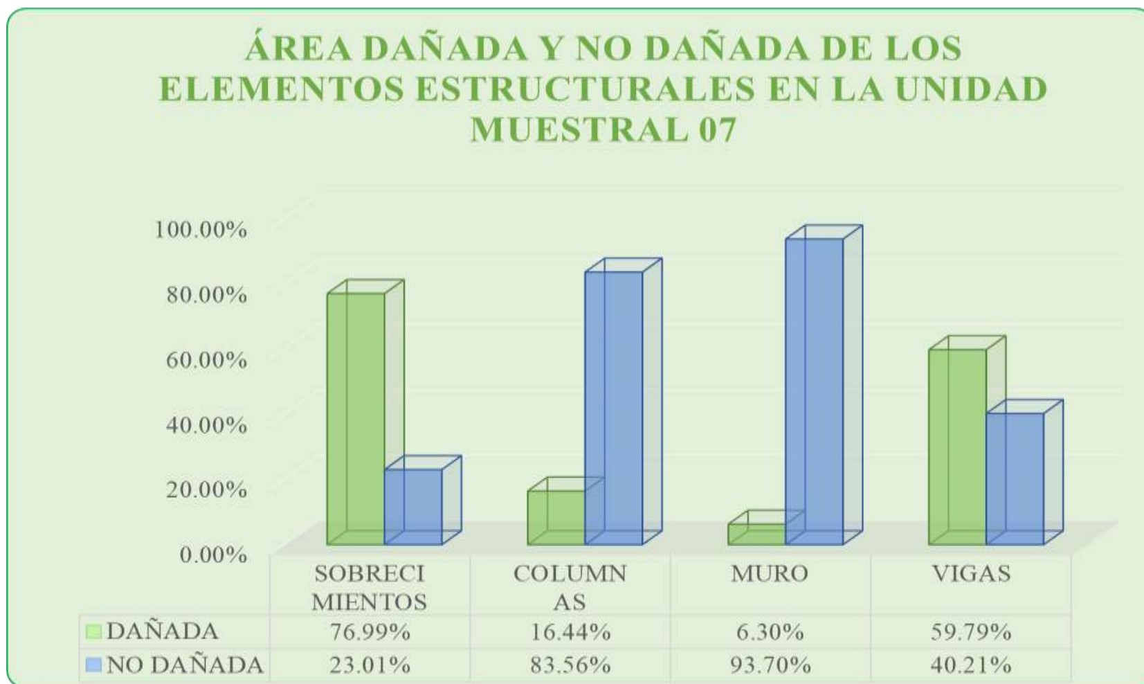
Gráfico 28: Porcentaje de Área dañada y no dañada de los Elementos Estructurales en la Unidad Muestral 07.
