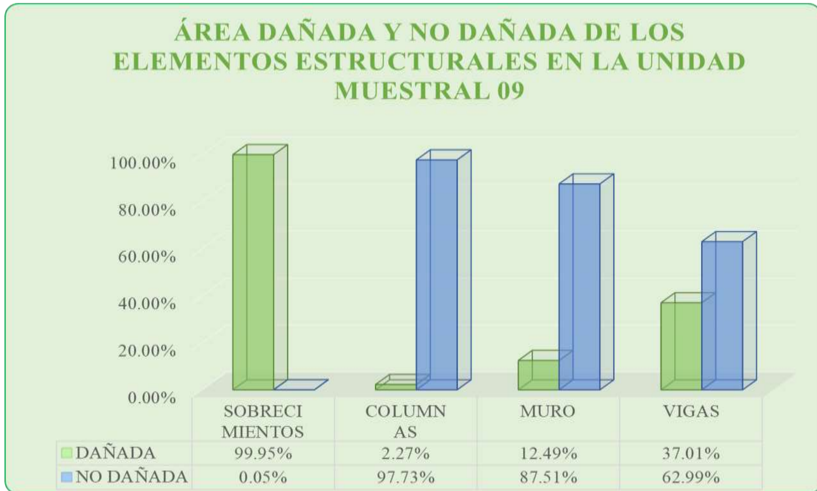
Gráfico 36: Porcentaje de Área dañada y no dañada de los Elementos Estructurales en la Unidad Muestral 09.
