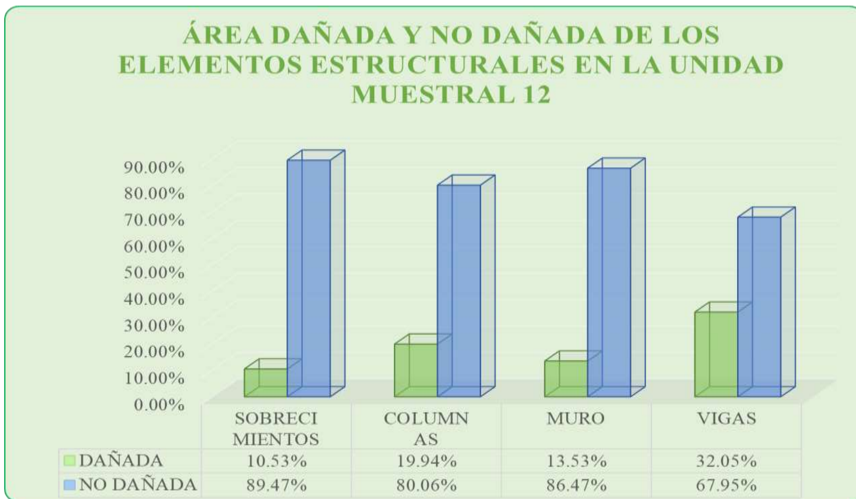
Gráfico 48: Porcentaje de Área dañada y no dañada de los Elementos Estructurales en la Unidad Muestral 12.
