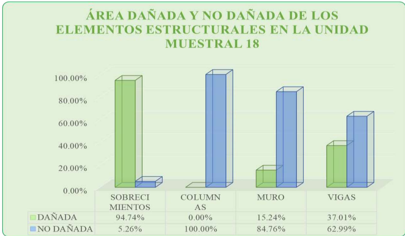
Gráfico 72: Porcentaje de Área dañada y no dañada de los Elementos Estructurales en la Unidad Muestral 18.
