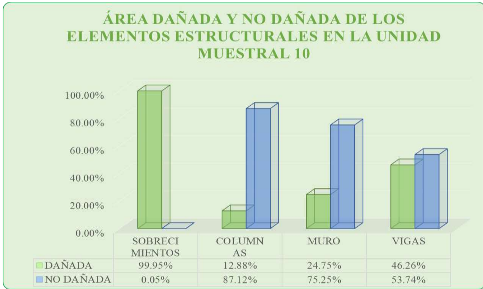
Gráfico 40: Porcentaje de Área dañada y no dañada de los Elementos Estructurales en la Unidad Muestral 10.
