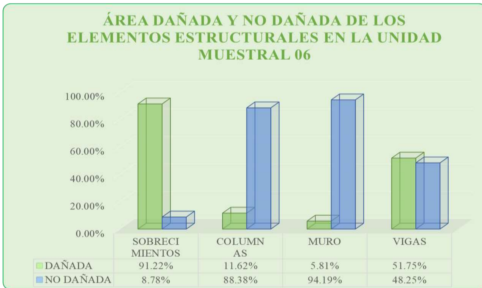
Gráfico 24: Porcentaje de Área dañada y no dañada de los Elementos Estructurales en la Unidad Muestral 06.
