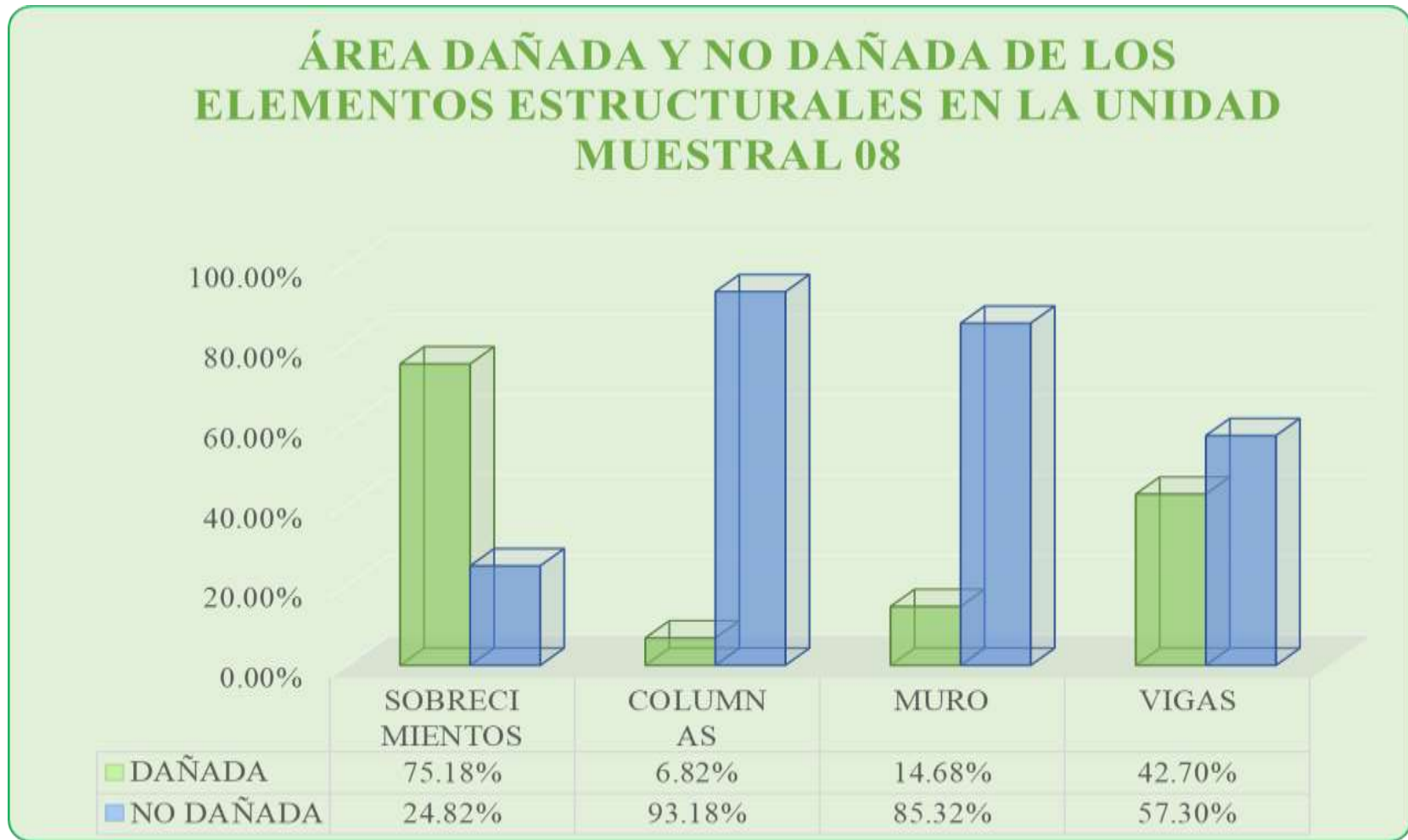
Gráfico 32: Porcentaje de Área dañada y no dañada de los Elementos Estructurales en la Unidad Muestral 08.
