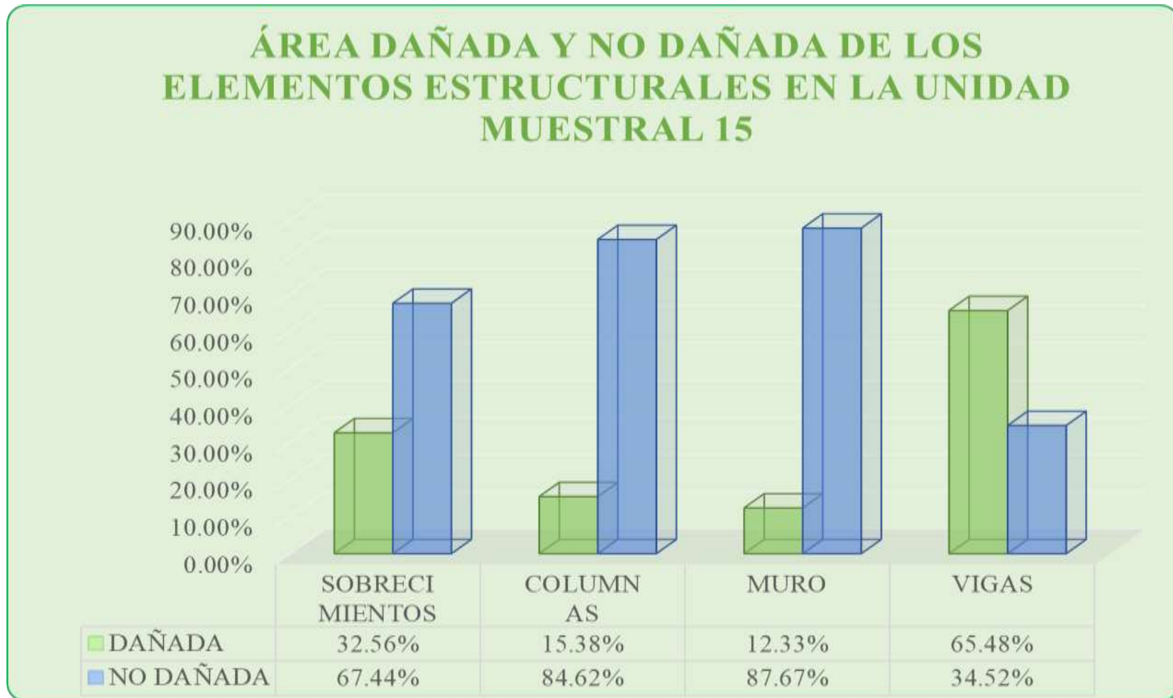
Gráfico 60: Porcentaje de Área dañada y no dañada de los Elementos Estructurales en la Unidad Muestral 15.
