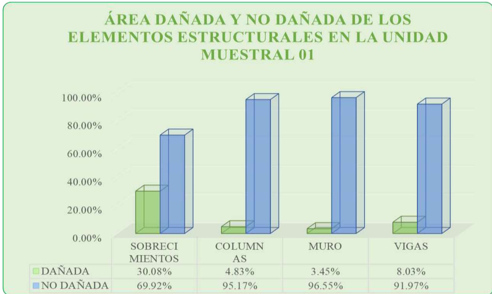
Gráfico 4: Porcentaje de Área dañada y no dañada de los Elementos Estructurales en la Unidad Muestral 01.
