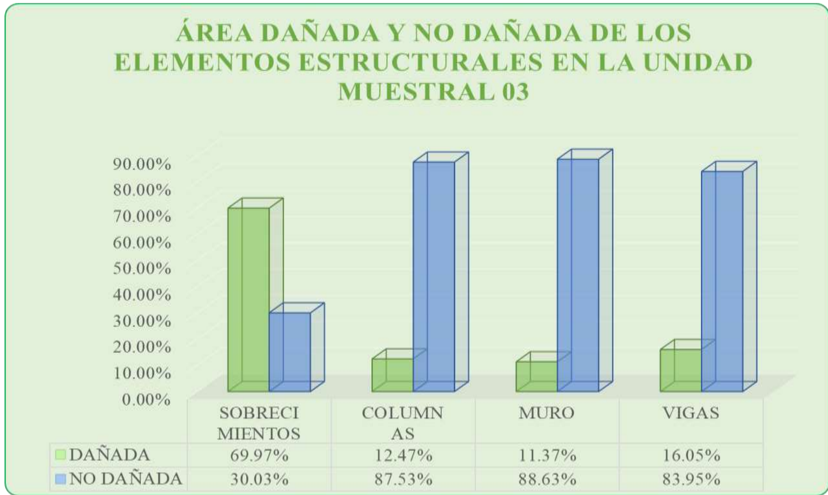
Gráfico 12: Porcentaje de Área dañada y no dañada de los Elementos Estructurales en la Unidad Muestral 03.
