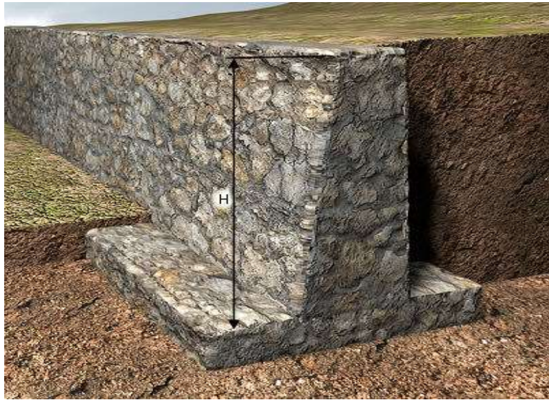
Figura 19: Sobrecimientos de concreto ciclópeo.
