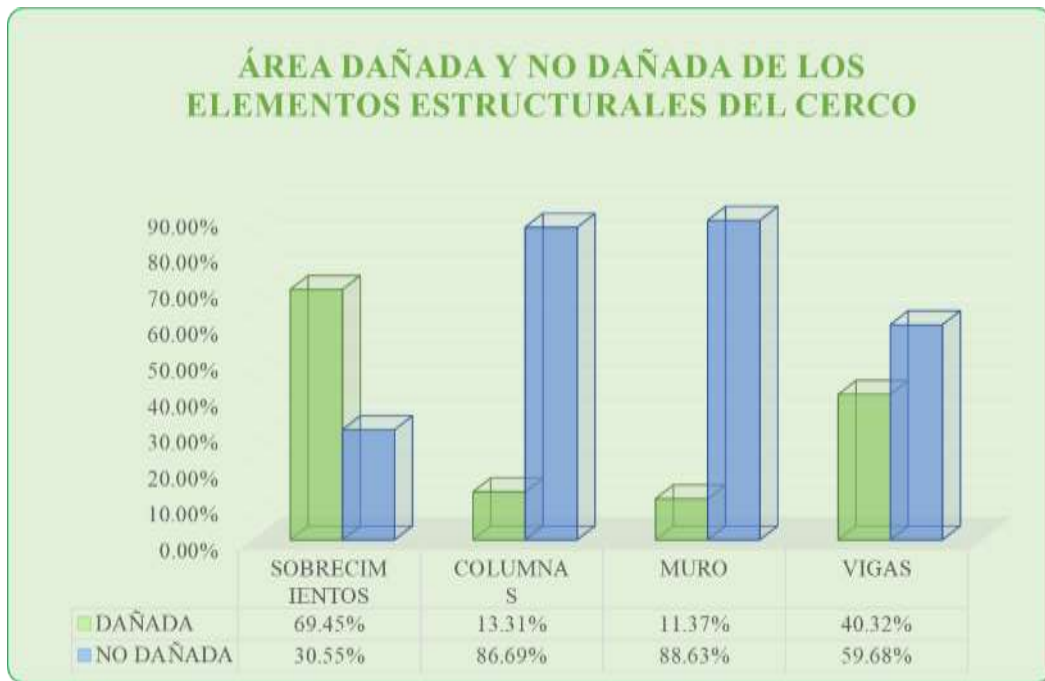
Gráfico 1: Áreas Afectadas y No Afectadas de los Elementos Estructurales.
