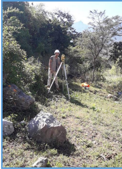
Fotografía 17: En la fotografía se puede apreciar el inicio del trabajo de levantamiento topográfico, ubicado en la fuente de afloramiento.
