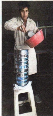
Imagen n° 18: En la imagen se puede apreciar el proceso del ensayo, donde la muestra ya pesada es ingresada a la torre de tamices ya seleccionados, para luego ser agitado en forma horizontal y vertical, de tal modo este proceso se realizó para todas más muestras ya cuarteadas. De tal manera se pesó la muestra retenida en cada tamiz.
