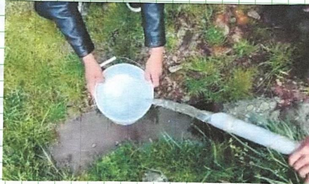
Imagen n° 1: En esta imagen se puede apreciar el Método Volumétrico.
