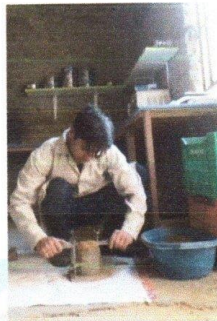
Imagen n° 27: En la imagen se puede apreciar uno de los procesos del ensayo de densidad mínima, de tal modo se visualiza el enrazado con la ayuda de una barra de acero, para luego ser limpiado con una pequeña brocha, para finalmente pesarlo en la balanza.
