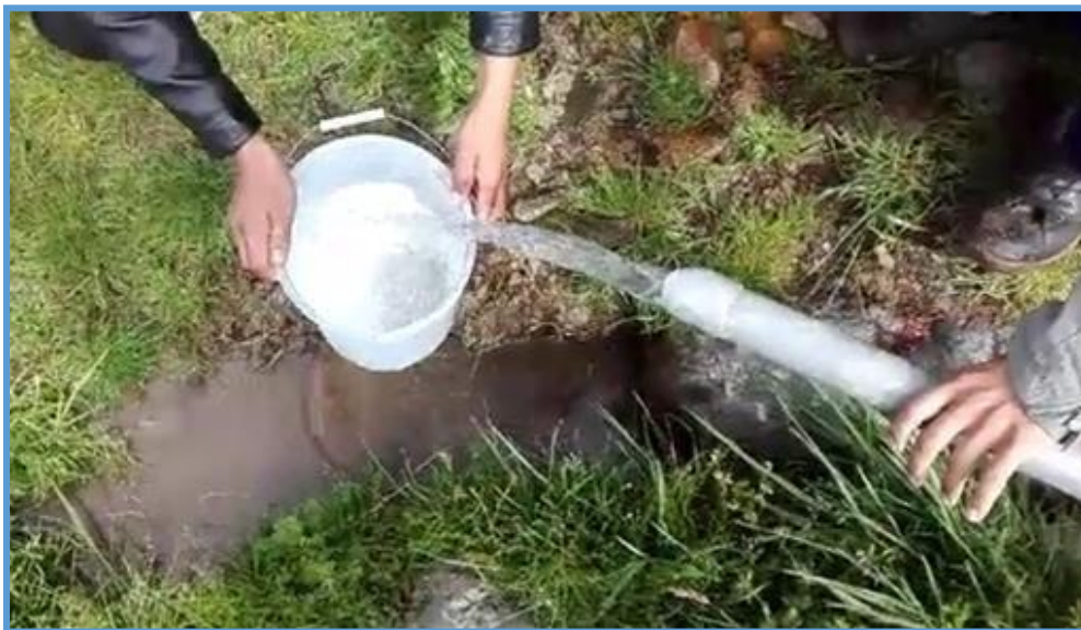
Fotografía 4: En la fotografía se puede apreciar el proceso del método volumétrico que es asignado para obtener el rendimiento del caudal.
