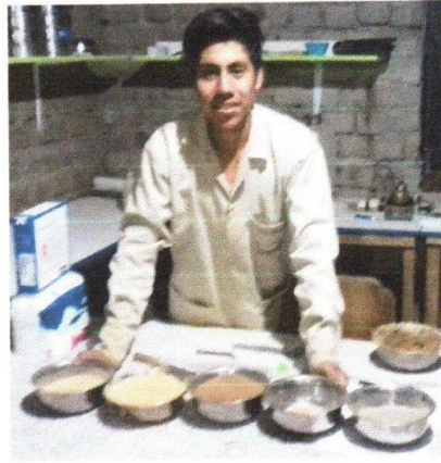
Imagen n° 22: En la imagen se puede apreciar una parte del ensayo del límite de consistencia de Atterberg (ASTM – D4318), ,
