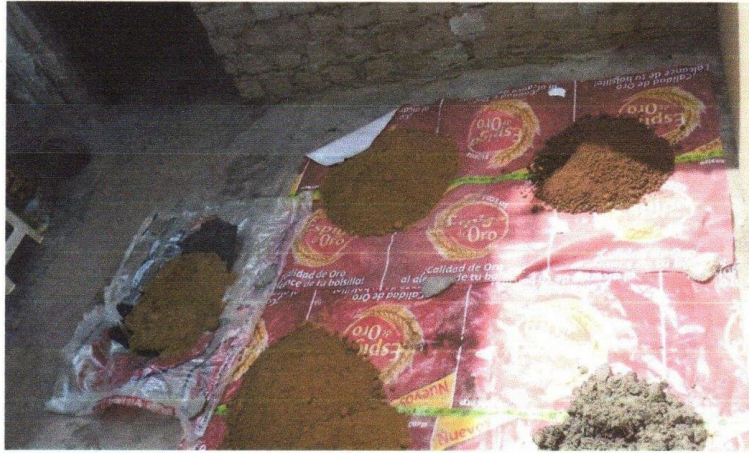
Imagen n° 13: En la imagen se puede apreciar parte de las muestras extraídas de las calicatas, que sirvió para el análisis granulométrico (ASTM-D421).
