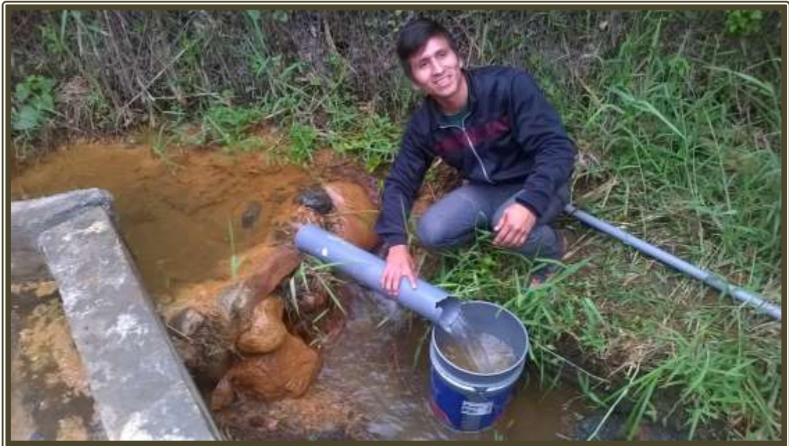
Fotografía 04: Se muestra el aforo del caudal de la captación en tiempo de estiaje, donde se obtuvo un caudal promedio de 1.82 l/s.
