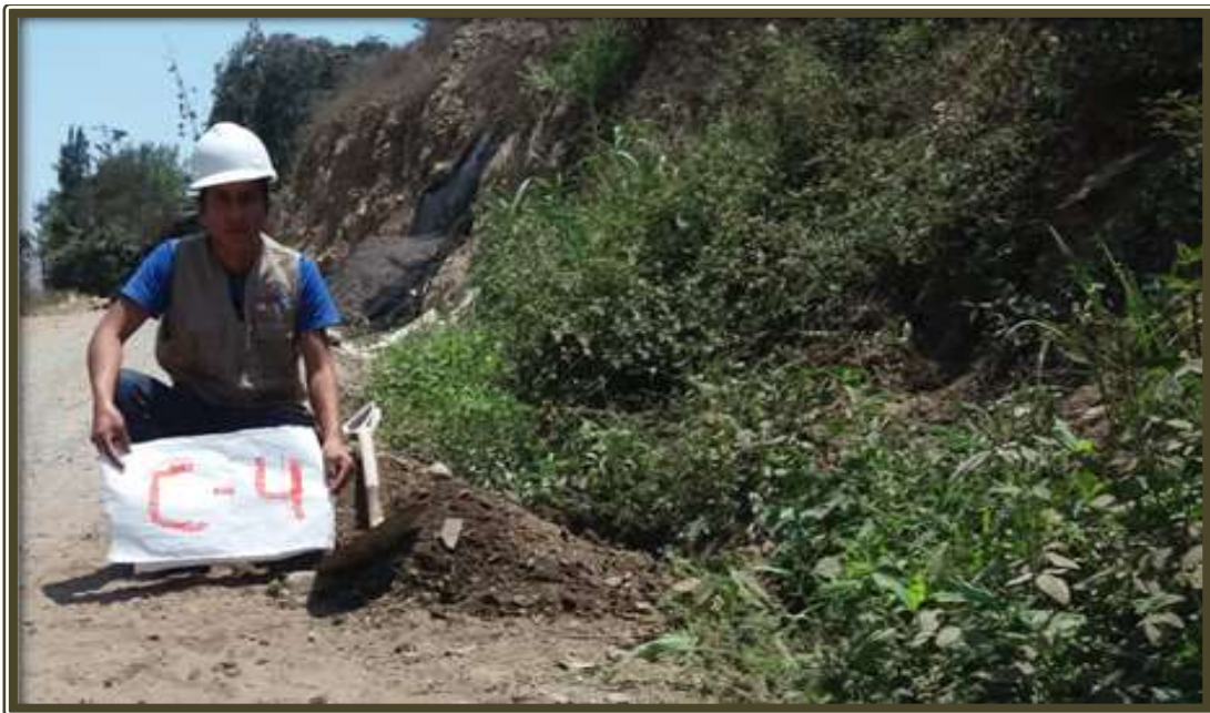
Fotografía 32: Se muestra la calita C-4, con fines de evaluar el tipo de suelo que se presenta en la línea de conducción.
