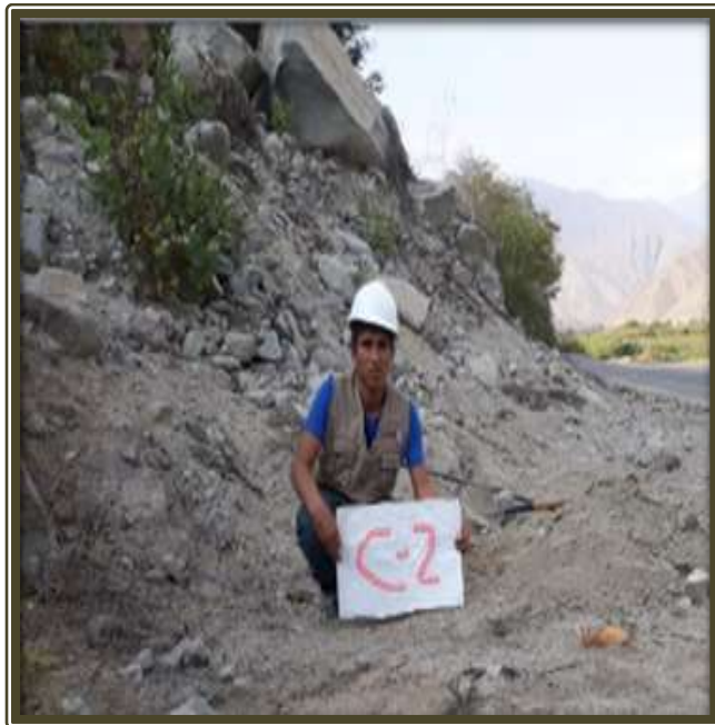
Fotografía 30: Se muestra la calita C-2, con fines de evaluar el tipo de suelo que se presenta en la línea de conducción.
