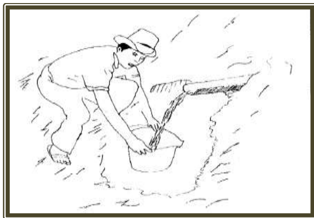
Figura 05: Aforo del agua por el método volumétrico
