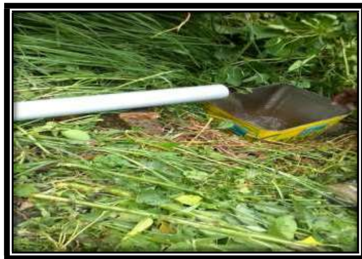
Figura 10: aforo del manantial mediante el método volumétrico
