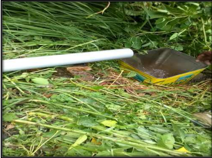
Fotografía N° 05: Aforo por el método volumétrico del manantial
