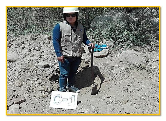
**Imagen N° 08:** Se puede apreciar realizando la calicata 1 en línea de conducción para el estudio de mecánica de suelos.
