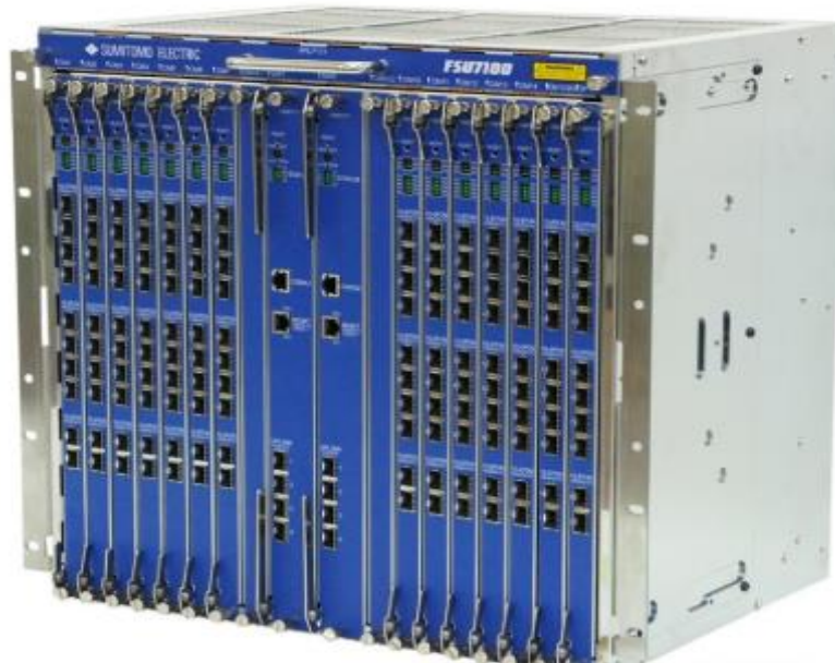
Gráfico Nro. 28: OLT (Optical Line Termination)
