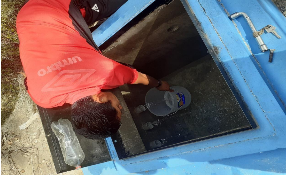
Fotografía N° 03: Aforando el caudal de agua
