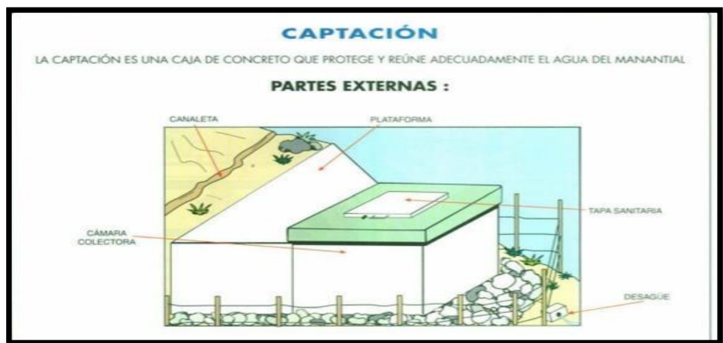
Figura 4: Captación de agua
