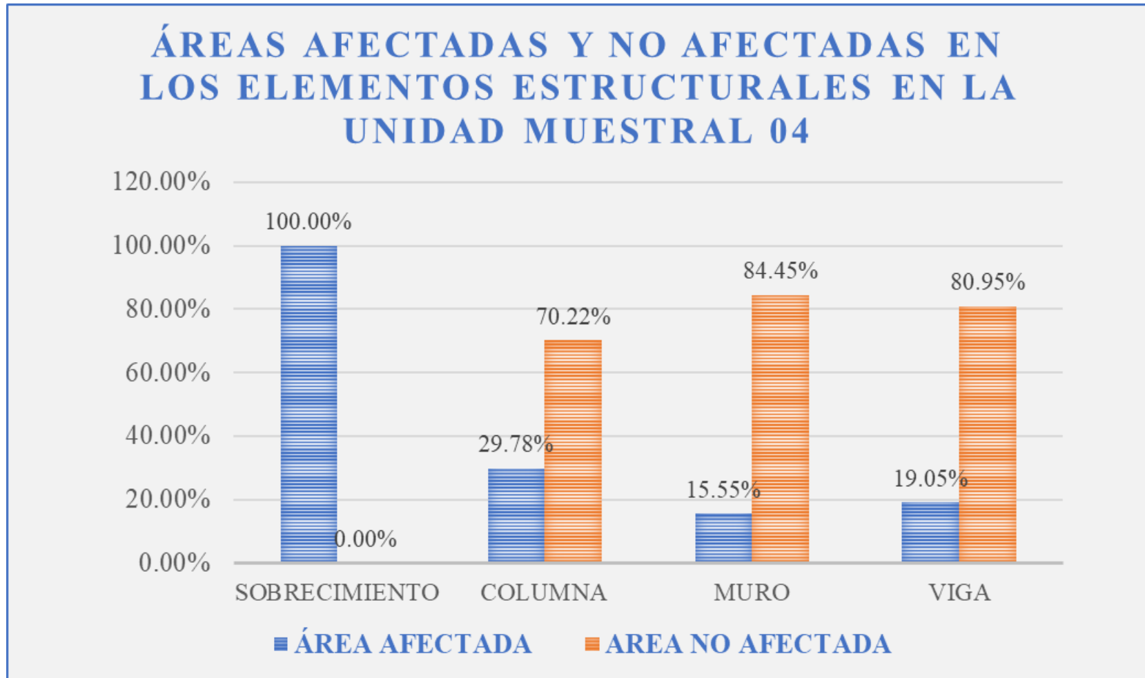
Gráfico 16: Porcentaje de Áreas afectadas y no afectadas en los Elementos Estructurales en la Unidad Muestral 04.
