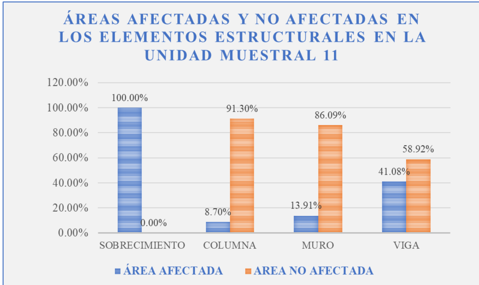
Gráfico 44: Porcentaje de Áreas afectadas y no afectadas en los Elementos Estructurales en la Unidad Muestral 11.
