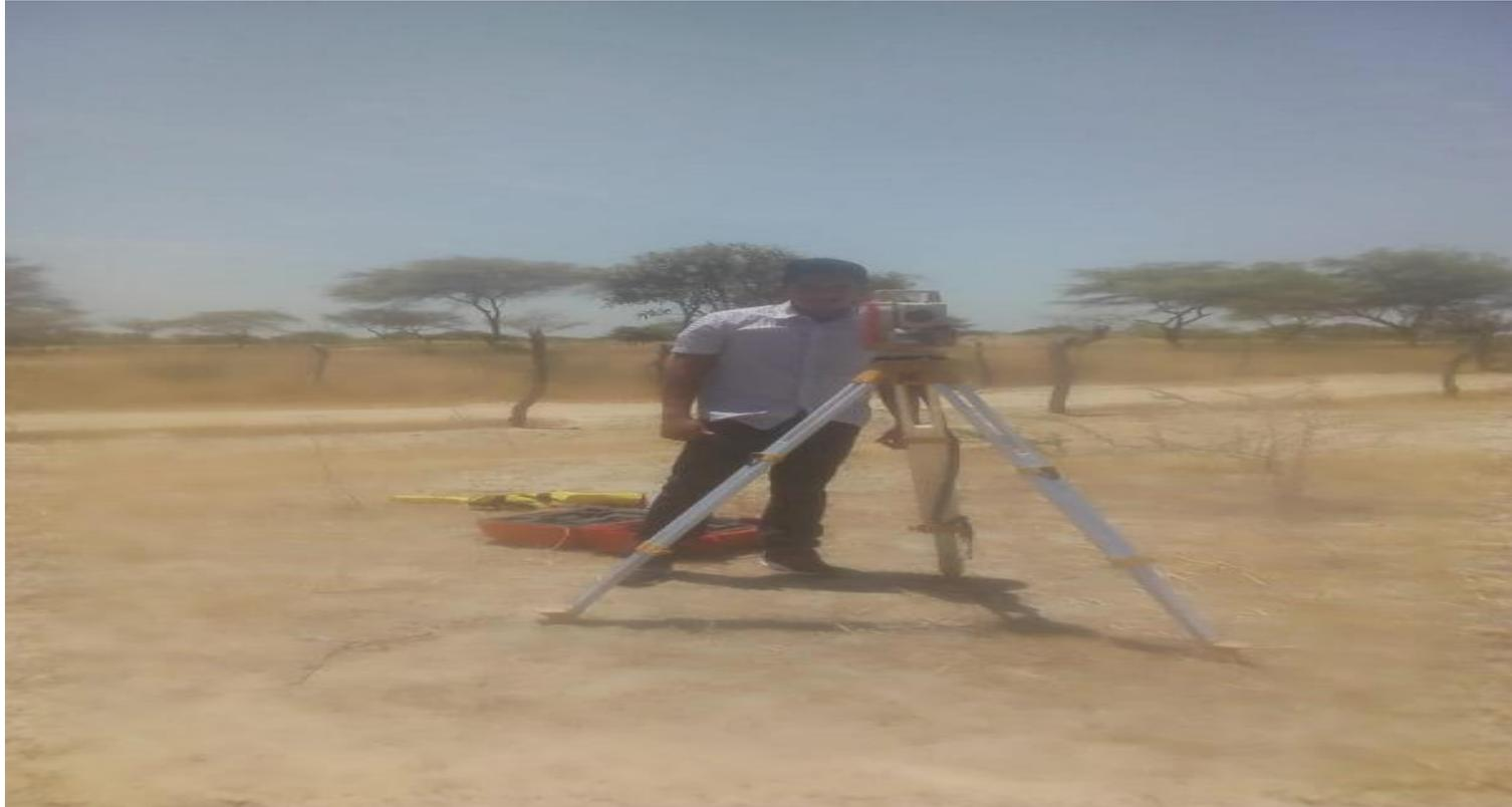
**IMAGEN. N. °3** Instalando los equipos para comenzar a relizar nuestra topografia Trabajo de campo realizando las curvas de nivel
