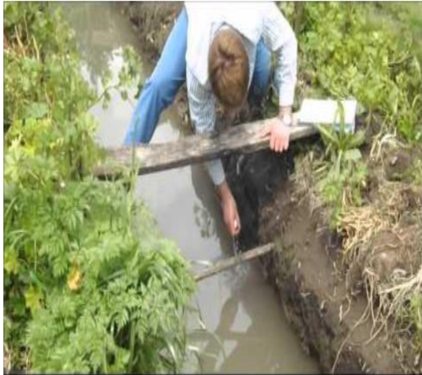
Gráfico 3: aforo con el método del flotador en el canal longavi – ciudad de parral – chile.
