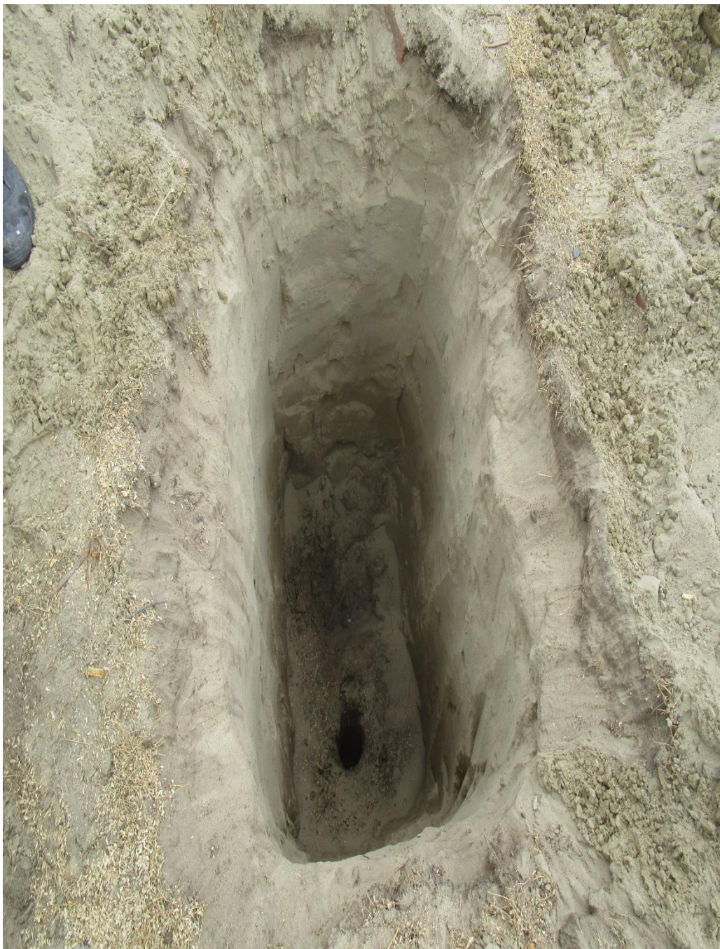
Gráfico 40: Vista panorámica del área de excavación de la calicata c-1 terminada
