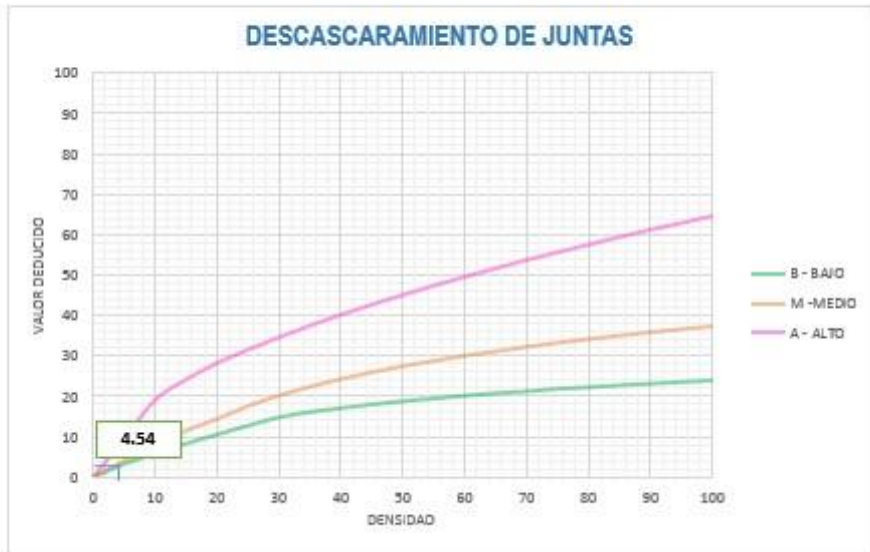
Figura 42: Descascaramiento de Juntas UM-02.
