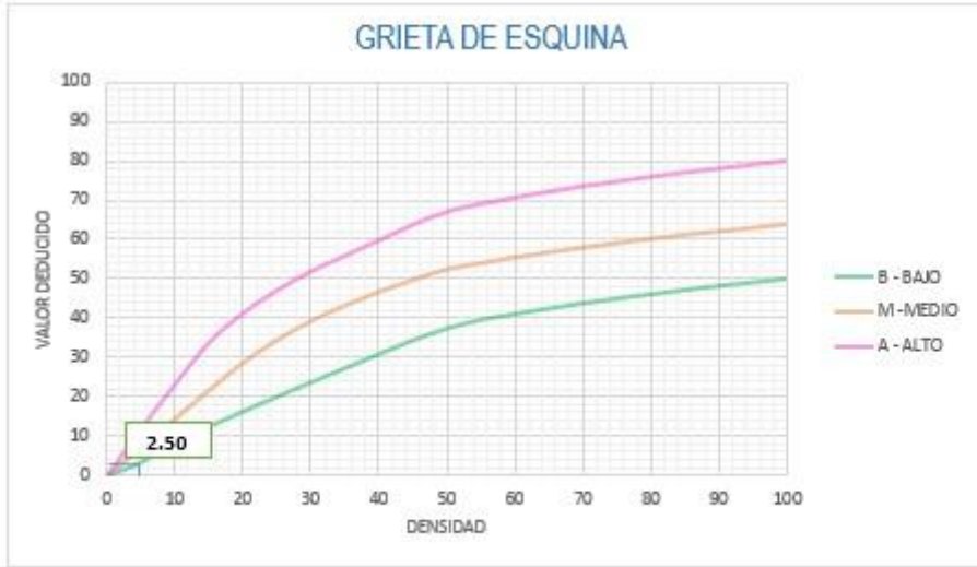
Figura 57: Grieta de Esquina UM-04.
