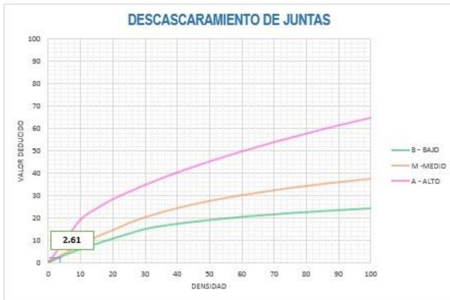
Figura 32: Descascaramiento de Juntas UM-01.
