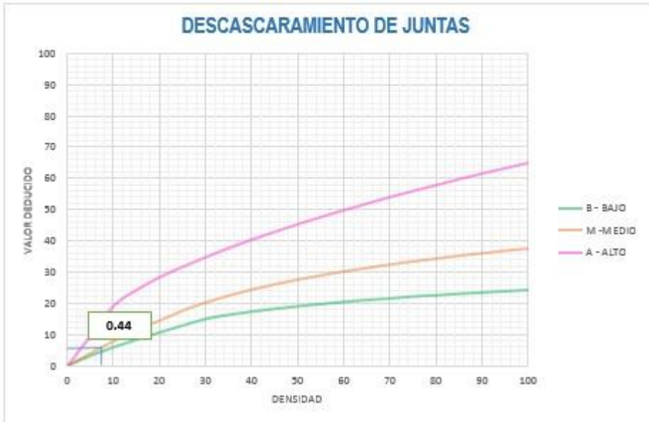
Figura 53: Descascaramiento de Juntas UM-03.
