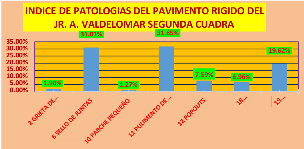
Gráfico n° 4.5: Índice de patologías del pavimento rígido del Jr. A. Valdelomar segunda cuadra
