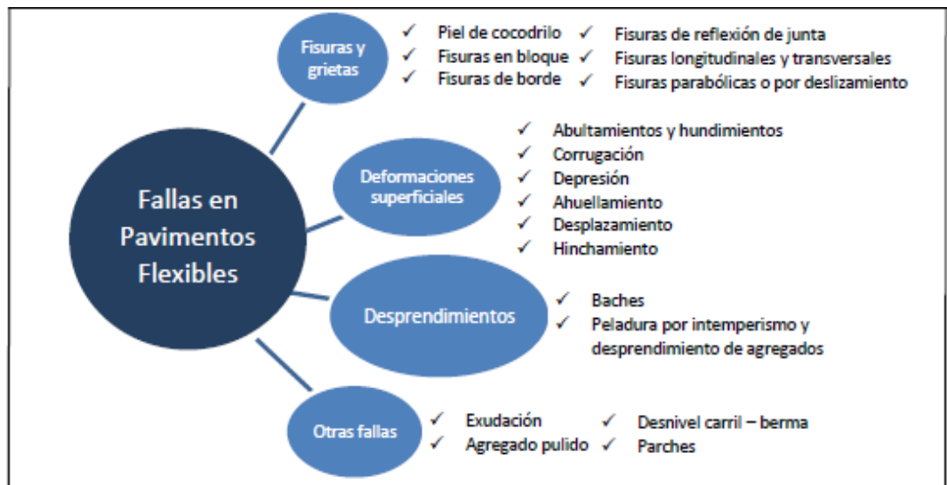
Imagen n°3. Fallas en pavimentos flexibles
