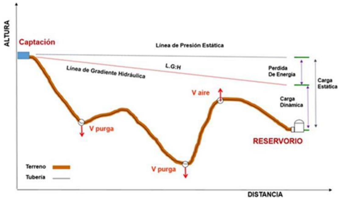
Figura 1: Esquema típico de Línea de Conducción
