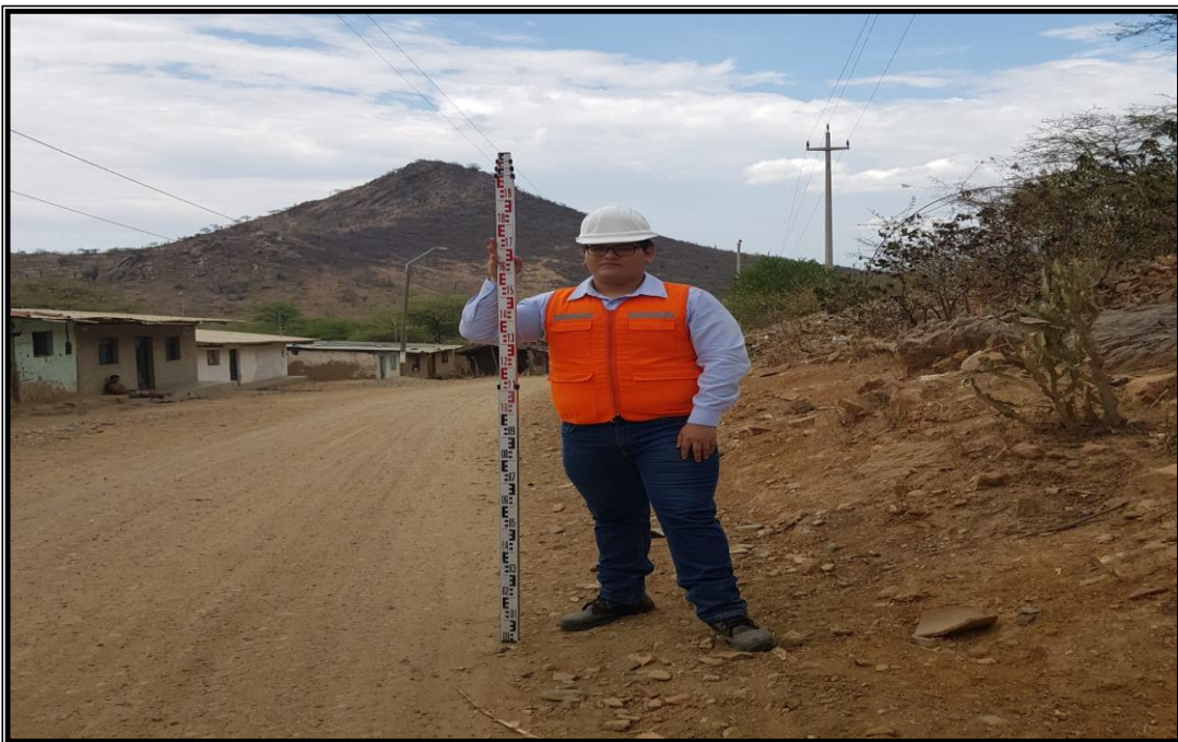
Figura 32: Levantamiento topográfico para cotas de buzones proyectados. Fuente: Elaboración propia.
