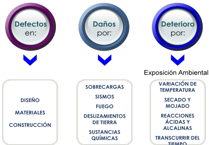
Clasificación general de patologías en las edificaciones
