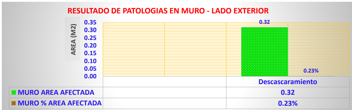
Grafico 91: Muestra 08, Patología en Muro – Lado Exterior
