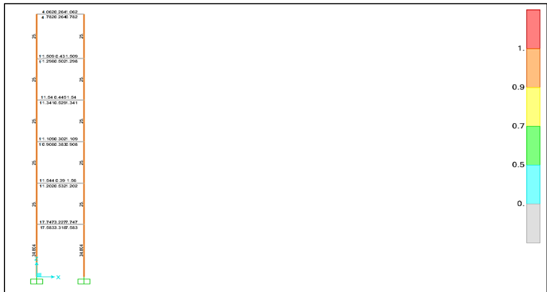
Figura 47: Área de acero en columnas y vigas
