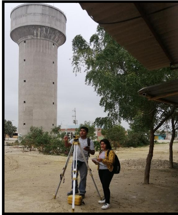
FOTOGRAFÍA 05: Anotando las cotas del terreno
