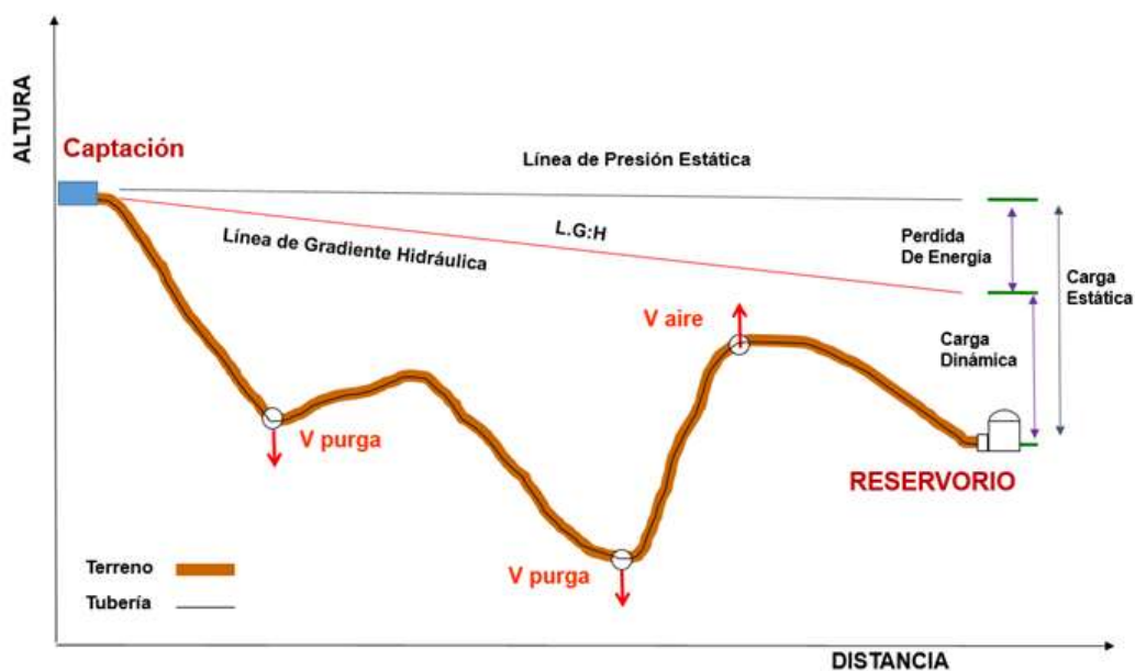
IMAGEN N° 2: Línea de Conducción.
