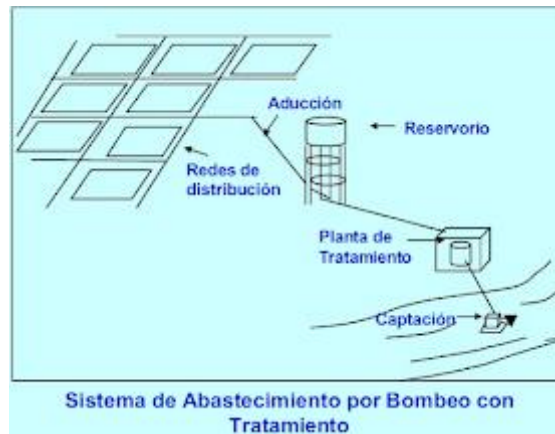
Ilustración 3: Sistema de abastecimiento por bombeo con tratamiento
