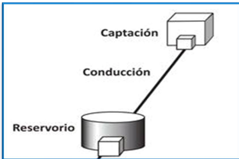
Imagen 12: Línea de conducción
