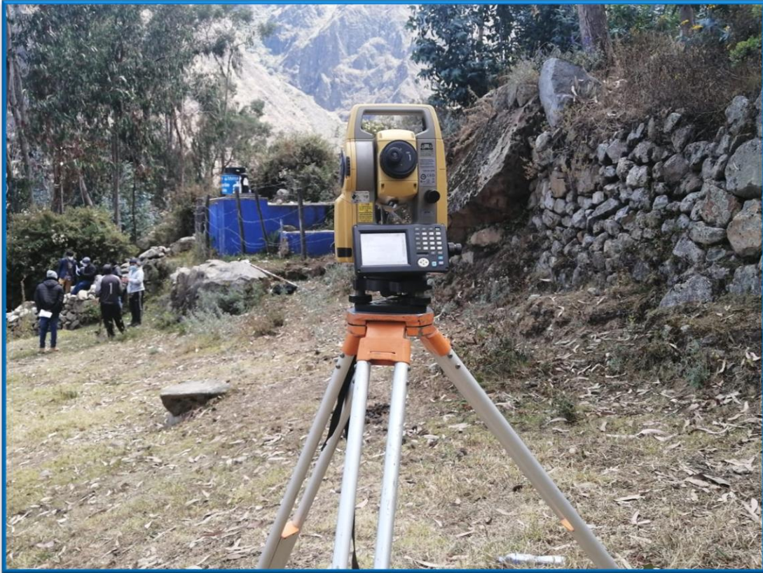
Fotografía 11: Realizando el levantamiento topográfico
