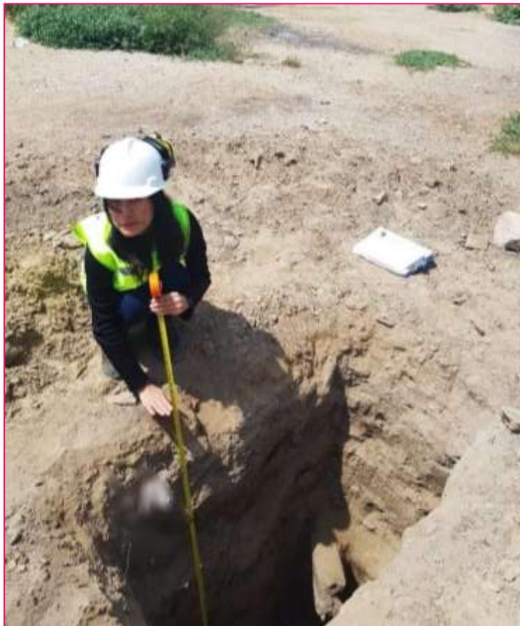
Imagen 20: Calicata en PTAP
