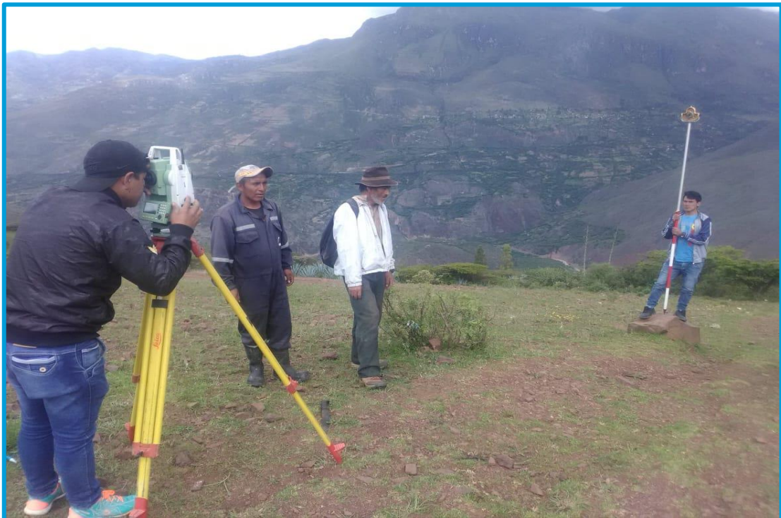
Imagen 17. Tomando coordenadas del punto auxiliar para dar inicio el levantamiento topográfico.
