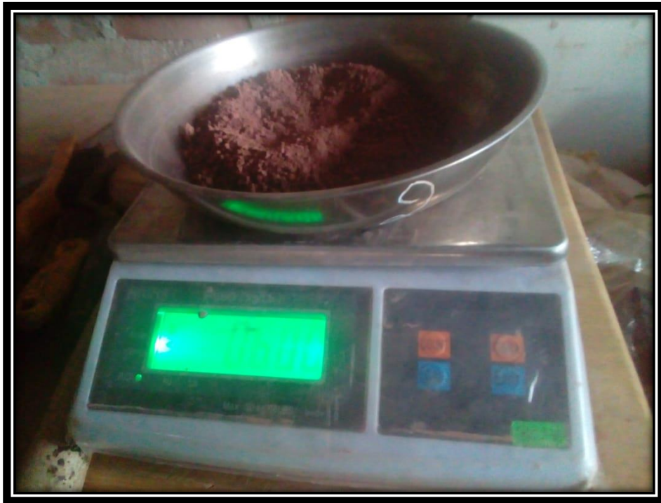
Figura 142: Peso de la muestra del suelo para la granulometría.
