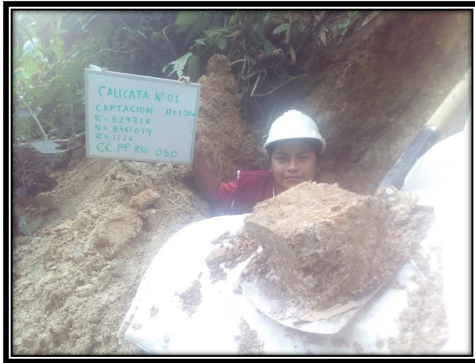
Figura 139: Extracción de la muestra para el estudio de suelos de la calicata de la captación.
