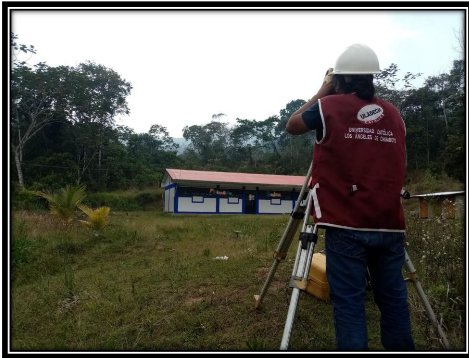
Figura 138: Vista panorámica del levantamiento topográfico del nivel inicial de centro educativo del centro poblado Rio Oso.
