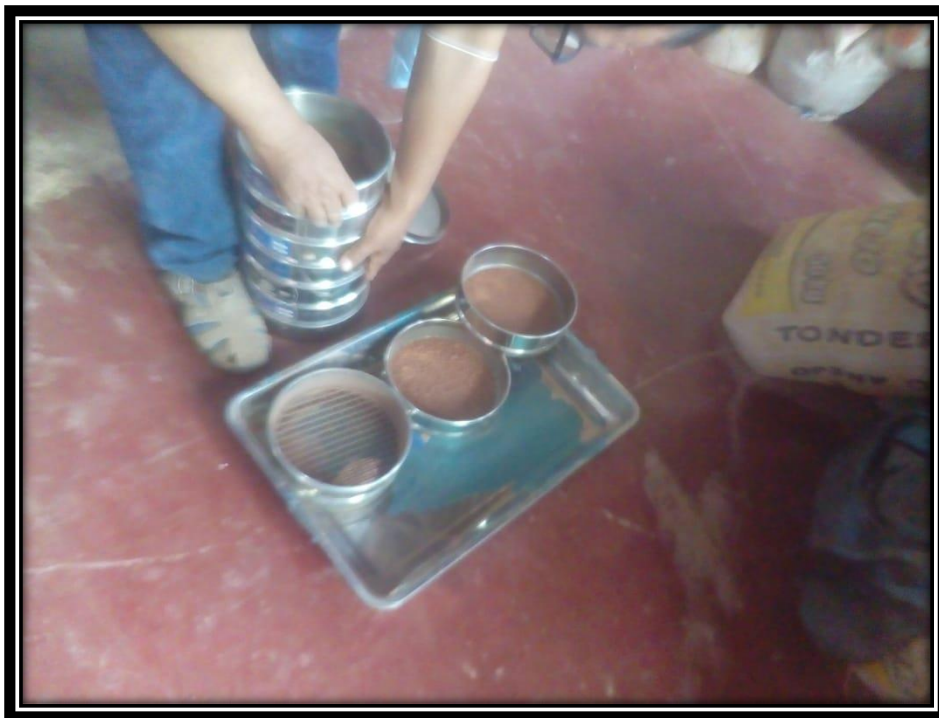
Figura 144: Proceso de separación de la muestra en los tamices.
