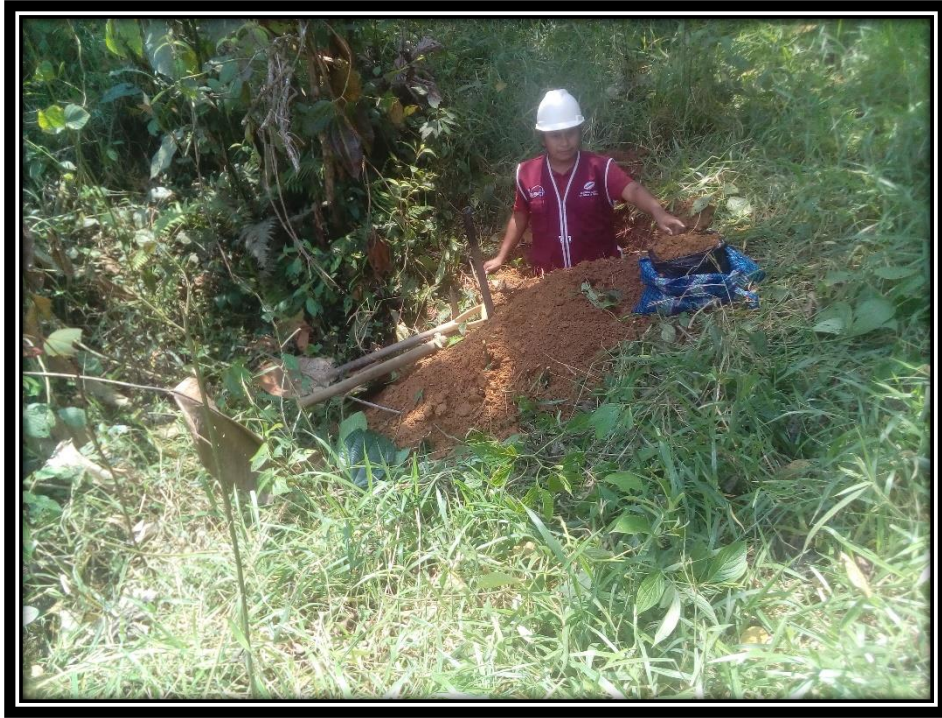
Figura 141: Extracción de la muestra para el estudio de suelos de la calicata del pase aéreo de 10 ml.
