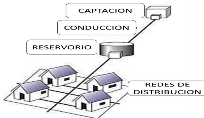
Figura 10: Componentes del sistema de agua potable. (35)
