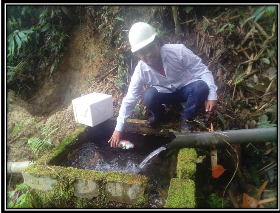
Figura 131: Realizando la toma de muestras para el estudio bacteriológico y físico-químico del agua del captación.
