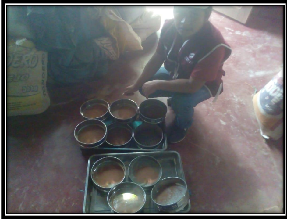
Figura 145: Proceso de separación de la muestra en los tamices.
