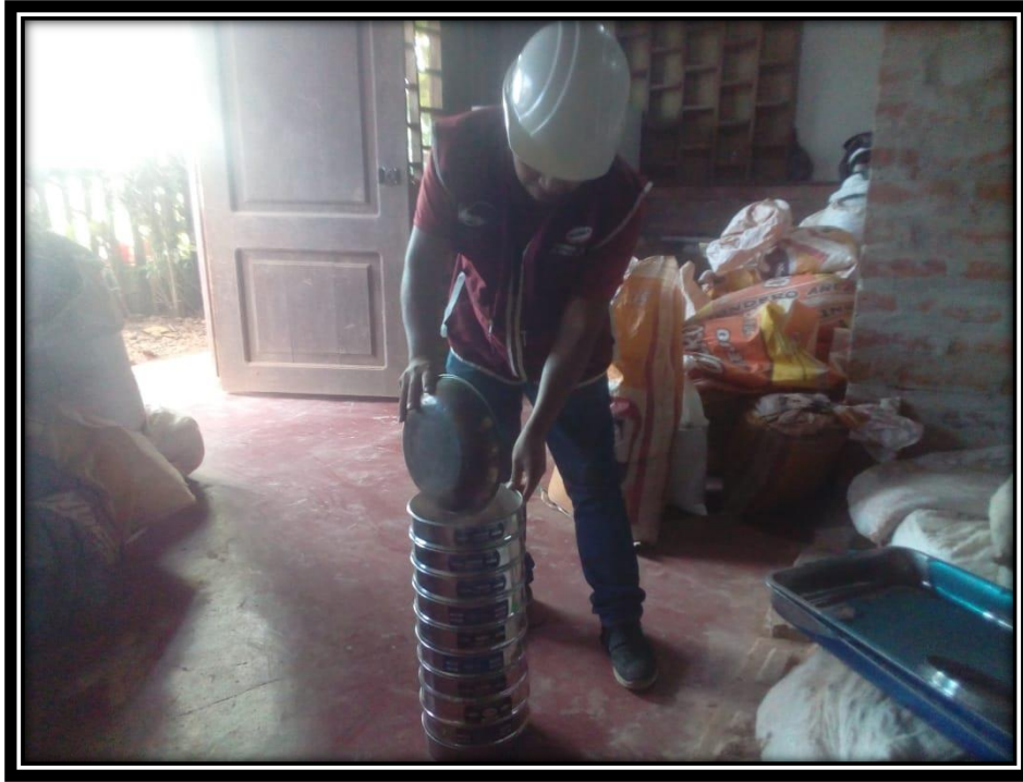
Figura 143: Proceso de tamizado de la muestra.
