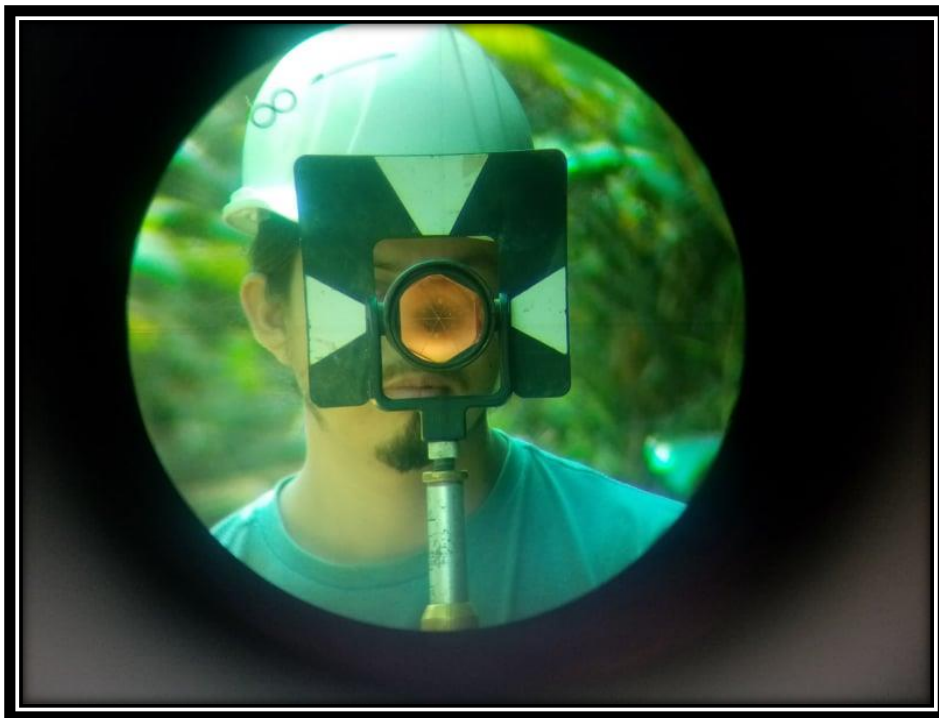
Figura 136: Vista panorámica del prismo a través de la estación total.
