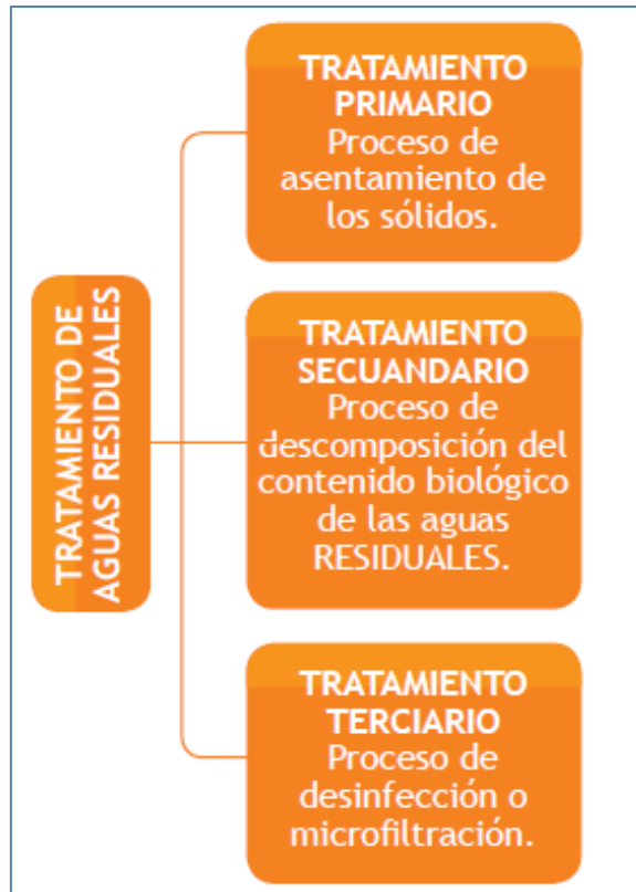
Figura 9. Esquema de tratamiento de aguas residuales
