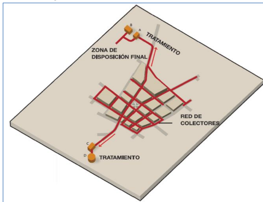
Figura 5. Red de alcantarillado convencional
