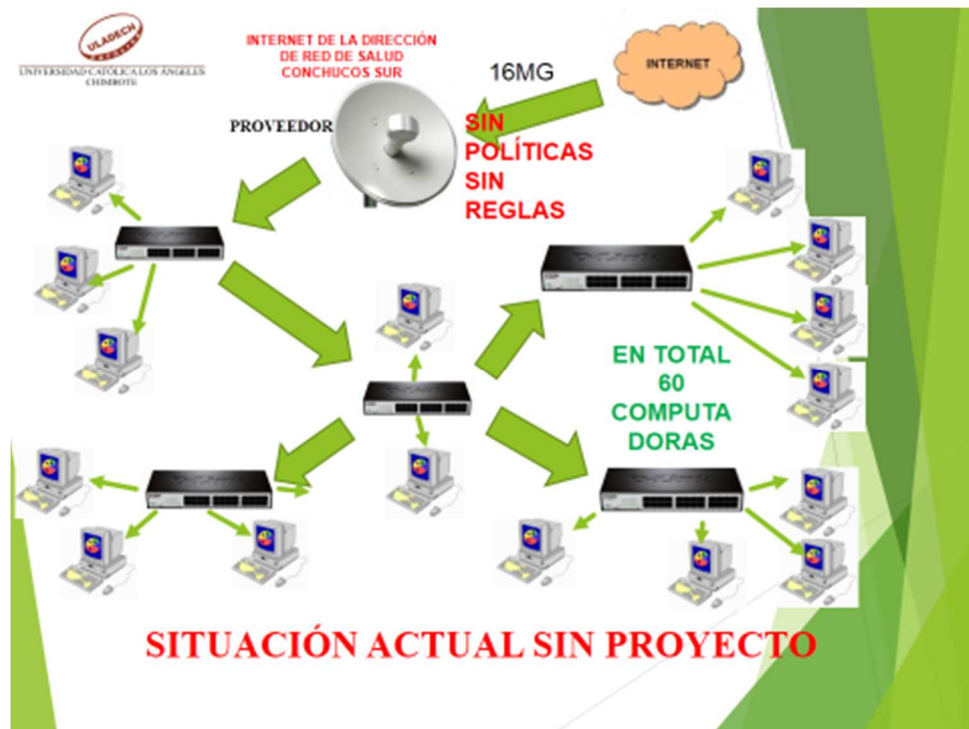
Gráfica Nro. 11: Simulación de red estructurado
