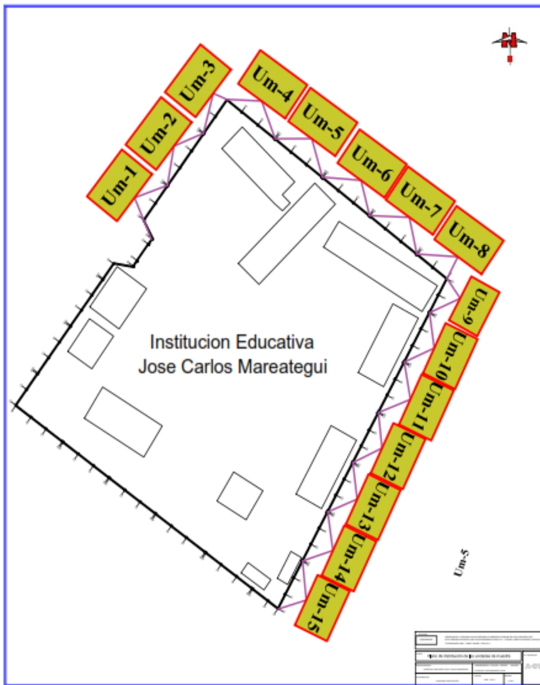
Anexo 05: Plano de planta de la distribución de unidades de muestra del cerco perimetrico
