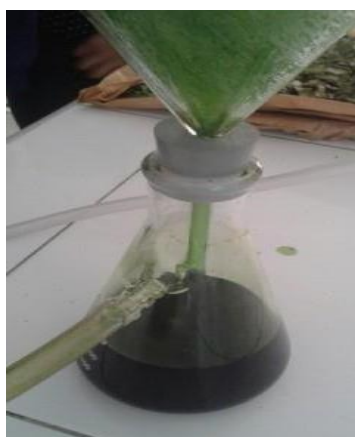
Fotografía 3: Proceso de filtración y se procedió a llevar al rotavapor
