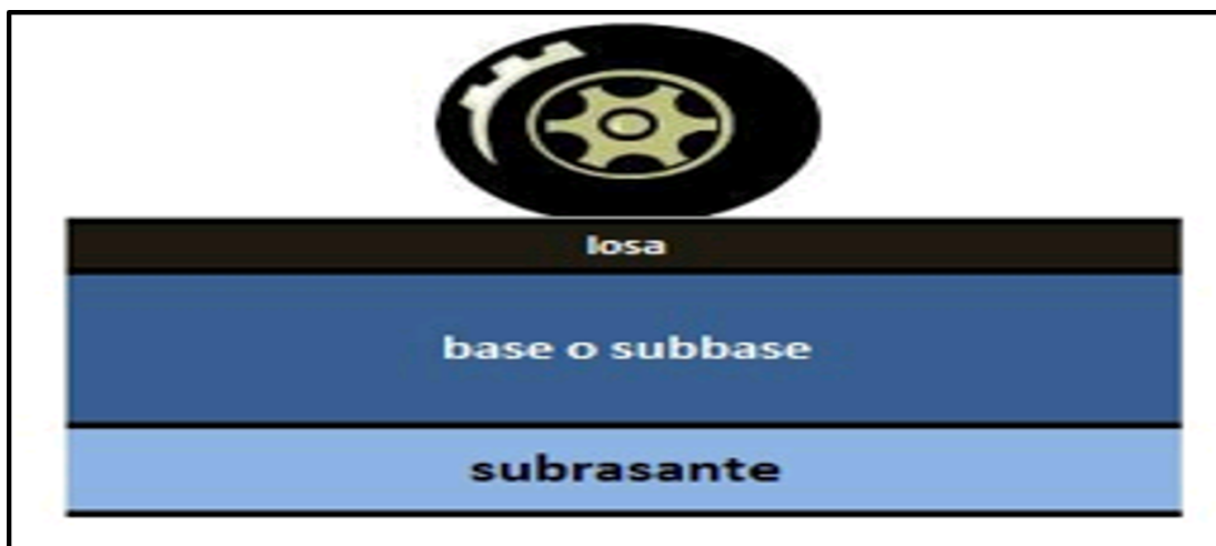
Figura 2.2: Composición de un pavimento rígido. Fuente: (Edgar Rodríguez, 2009).
