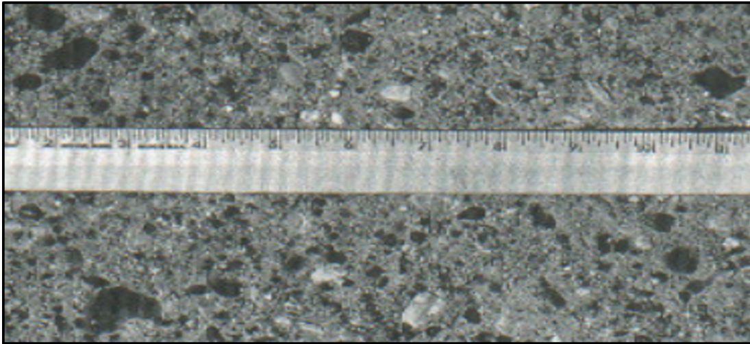
Figura 2.16: Pulimento de Agregados.
