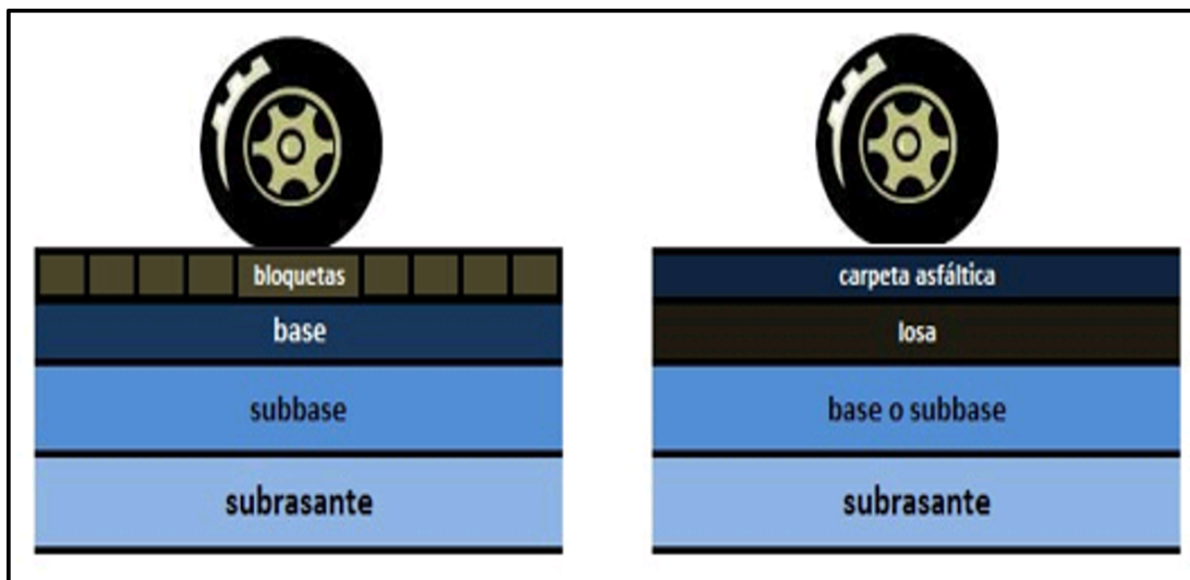
Figura 2.3: Composición de un pavimento mixto. Fuente: (Edgar Rodríguez, 2009).
