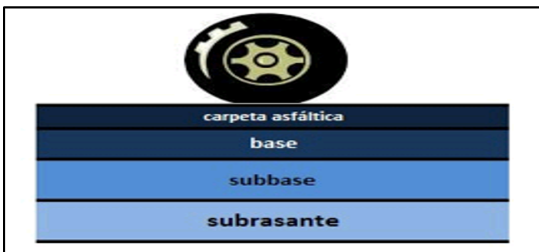
Figura 2.1: Composición de un pavimento flexible.
