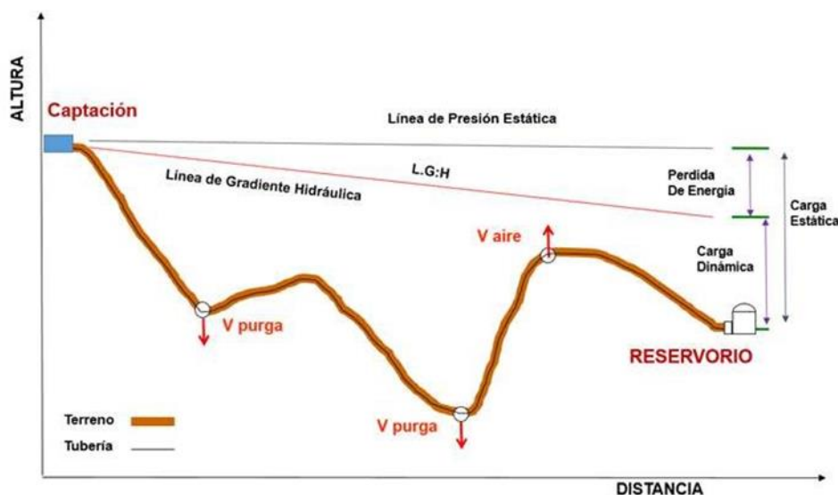
Figura 4: Línea de Conducción
