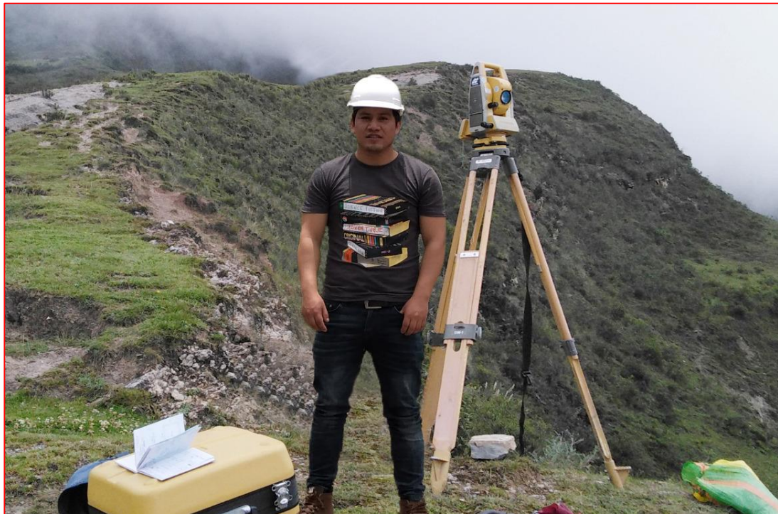
Imagen 30: Realizando levantamiento topográfico en el sistema de agua potable en el centro poblado de Cualuto.
