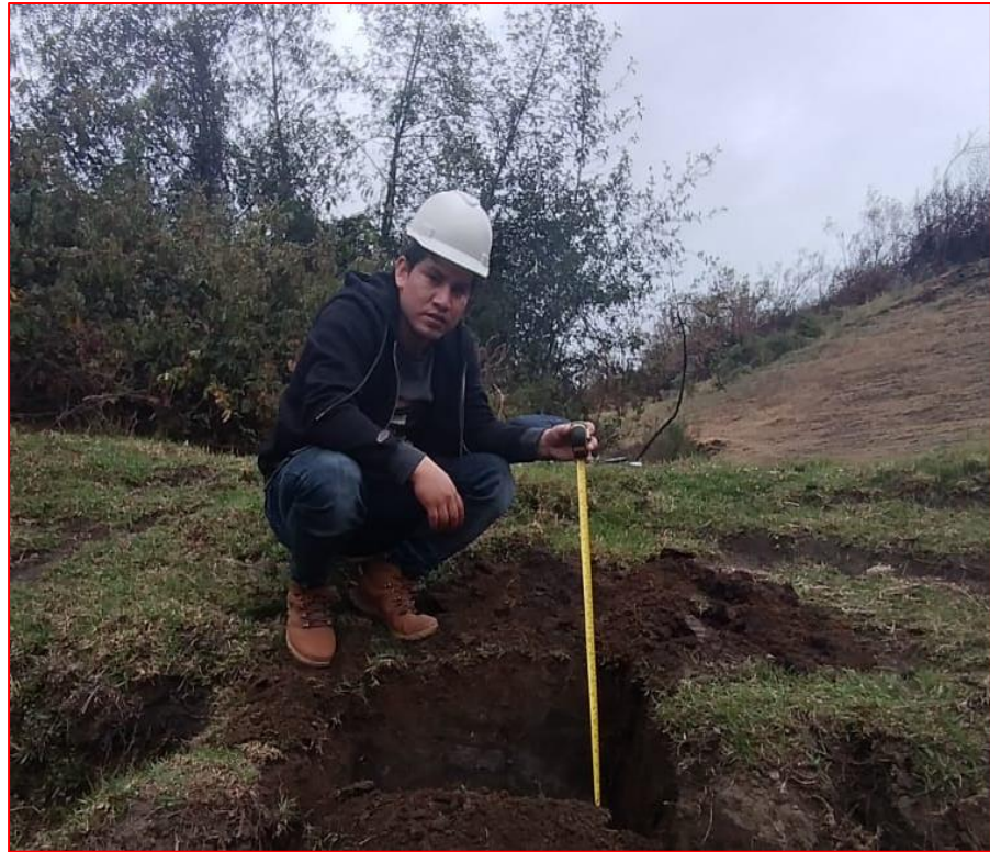
Imagen 19: Prueba de calicata
