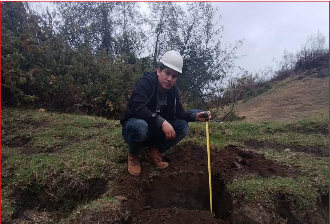
Imagen 34: Excavación de Calicata
